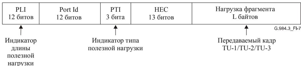
**Рисунок 1.7 – Структура кадра GEM с полезной нагрузкой в виде кадра TU**
