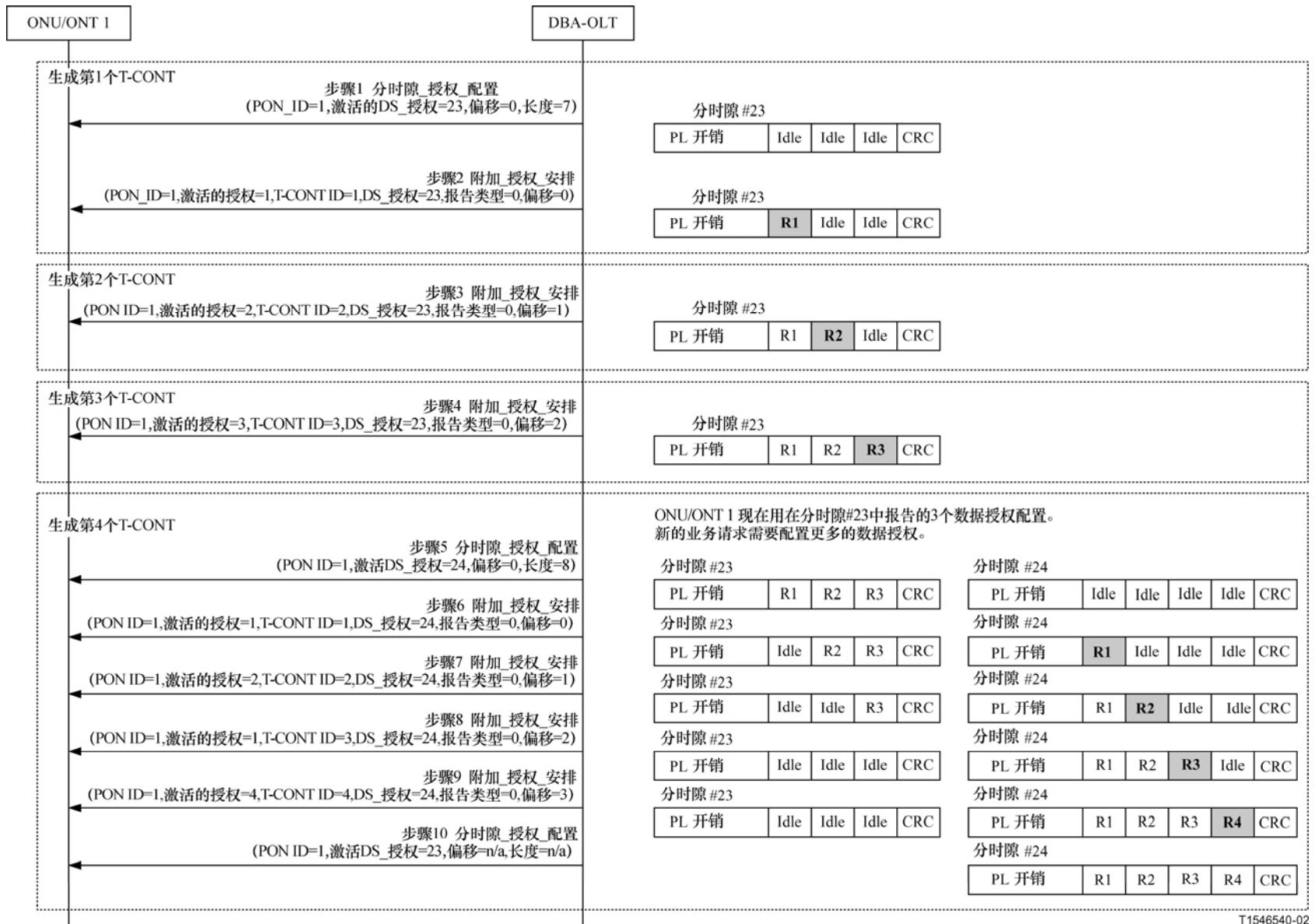
图 36/G.983.4—T-CONT的生成程序和一个ONU/ONT的无故障最小时隙传输
