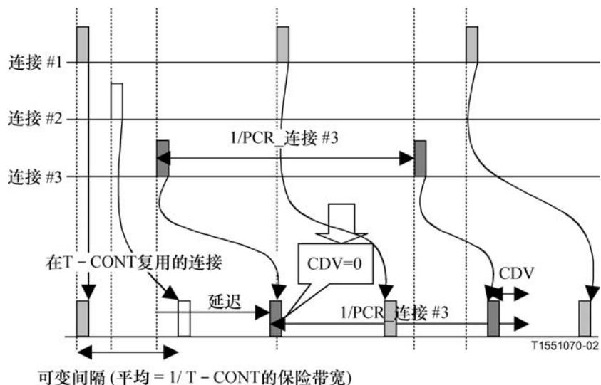
图 19/G.983.4—在T-CONT类型2复用连接的性能
