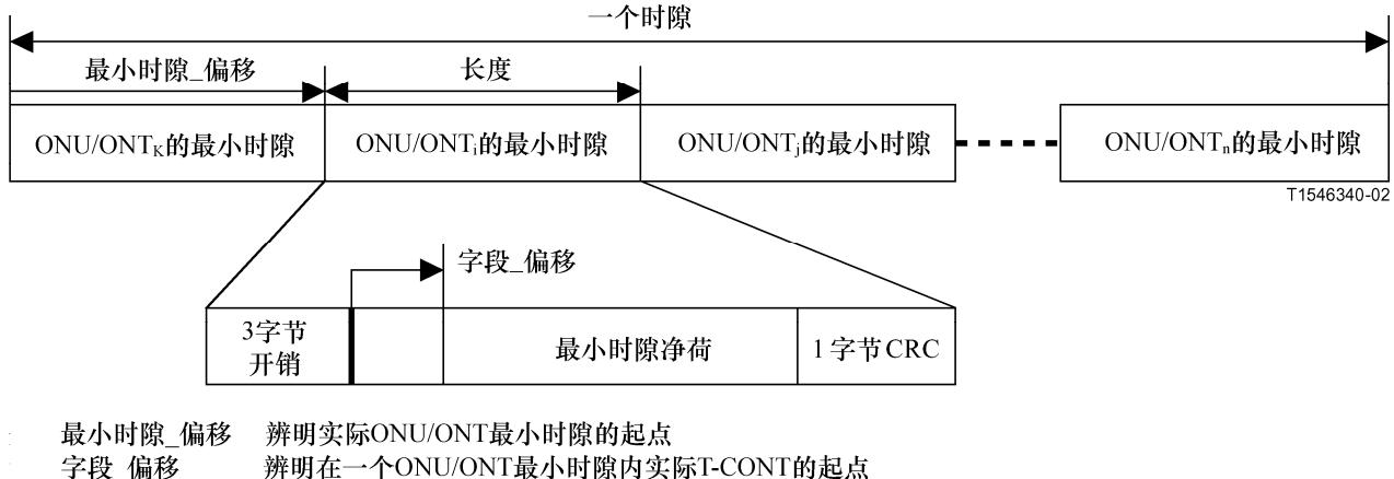
图 15/G.983.4一分时隙和最小时隙之间的关系
