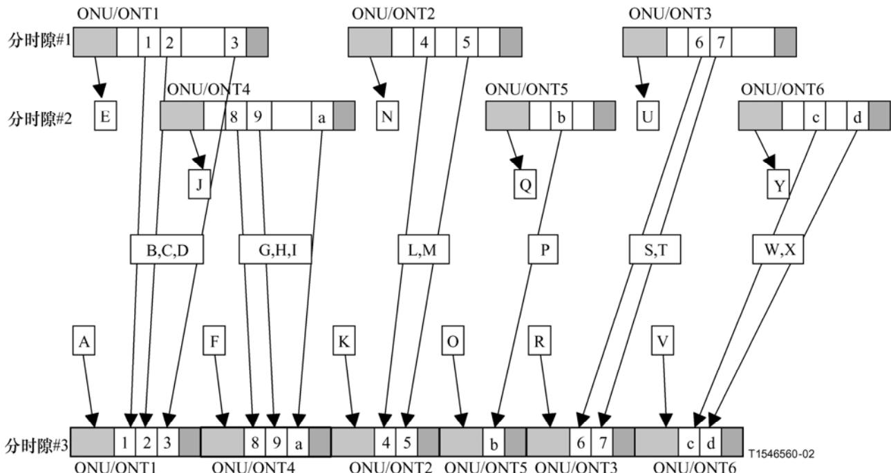
图 38/G.983.4—节省带宽的分时隙再配置的说明
