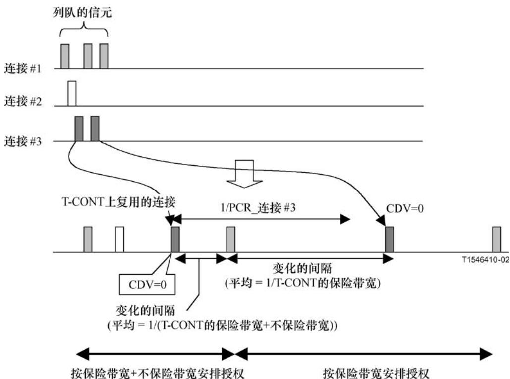
图 22/G.983.4—在T-CONT类型3的状态2复用连接的性能
