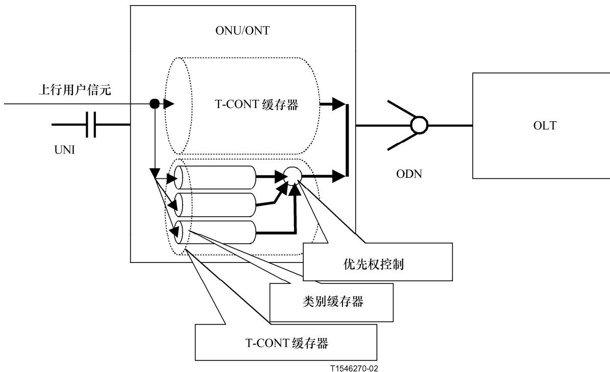
图 4/G.983.4—T-CONT缓存器内部机制示例
