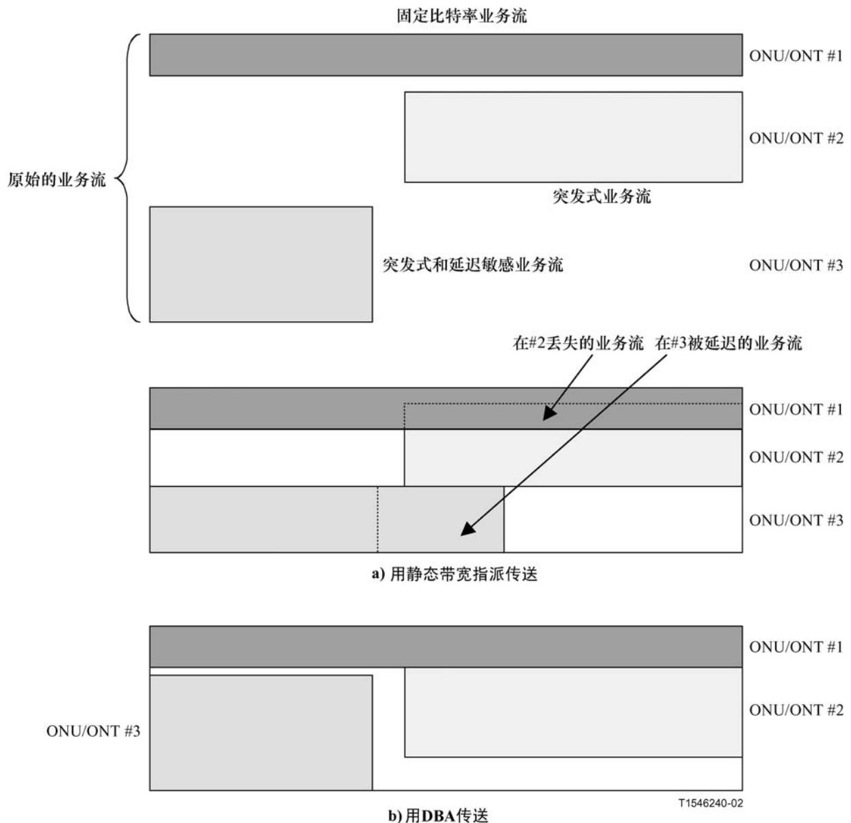
图 1/G.983.4—现行机制和DBA的比较
