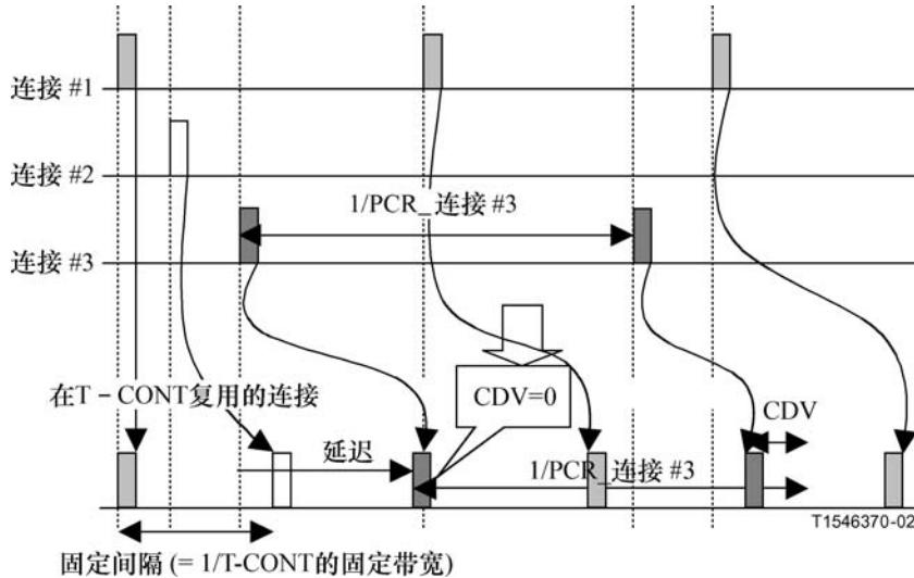
图 18/G.983.4—在 T-CONT 类型 1 复用连接的性能
