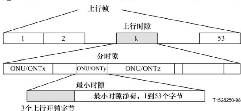
图 13/G.983.4—分\_时隙的格式
