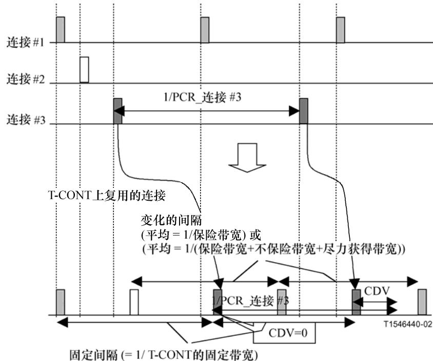
图 25/G.983.4—在T-CONT类型5的状态1和3复用连接的性能
