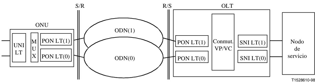
**Figura IV.1/G.983.1 – Modelo de sistema dúplex**
