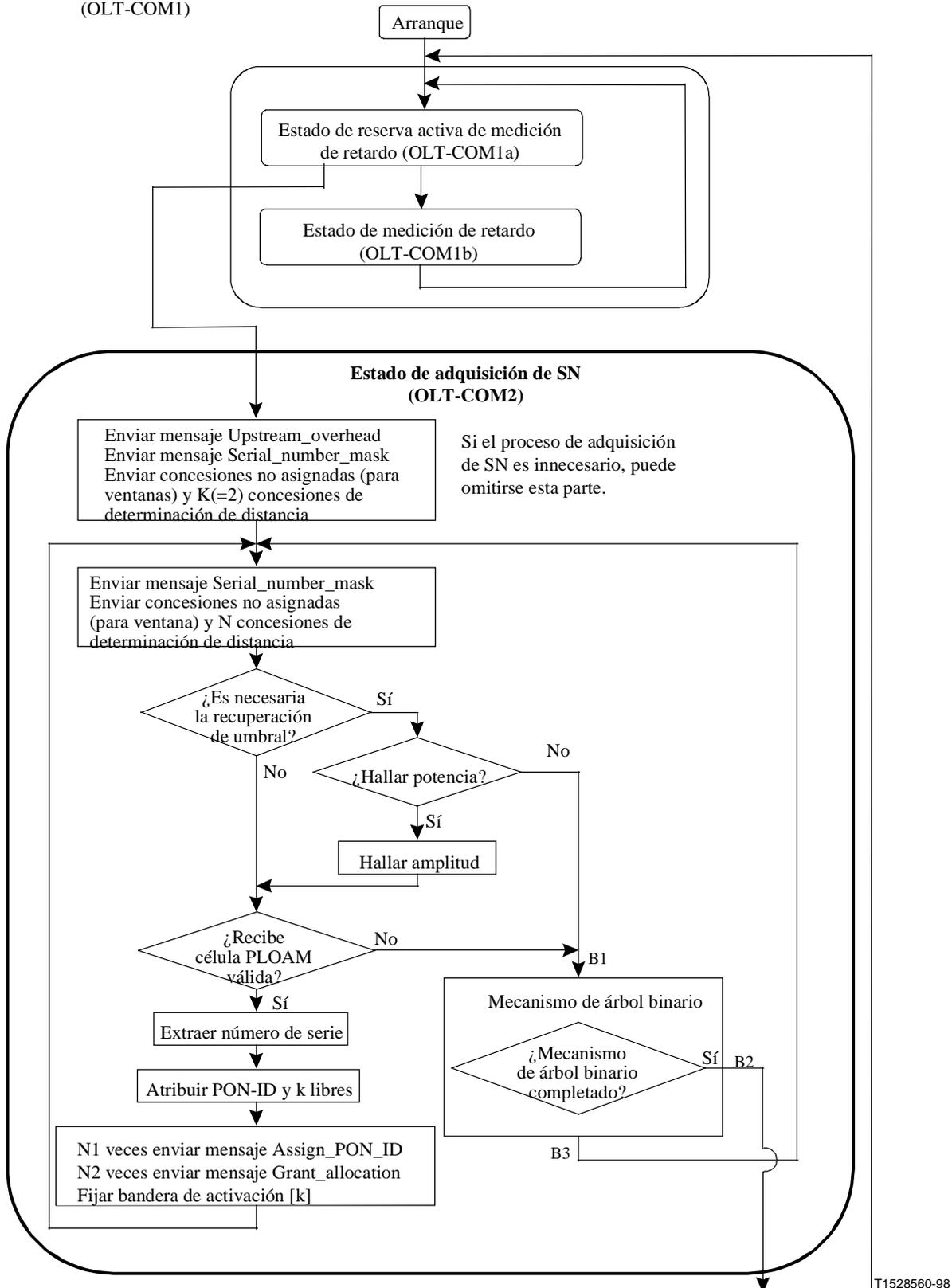
**Figura III.2/G.983.1 – Flujo de determinación de distancia [OLT] (ejemplo)**
