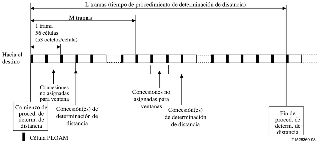
**Figura 26/G.983.1 – Apertura repetida de la ventana de determinación de distancia**
