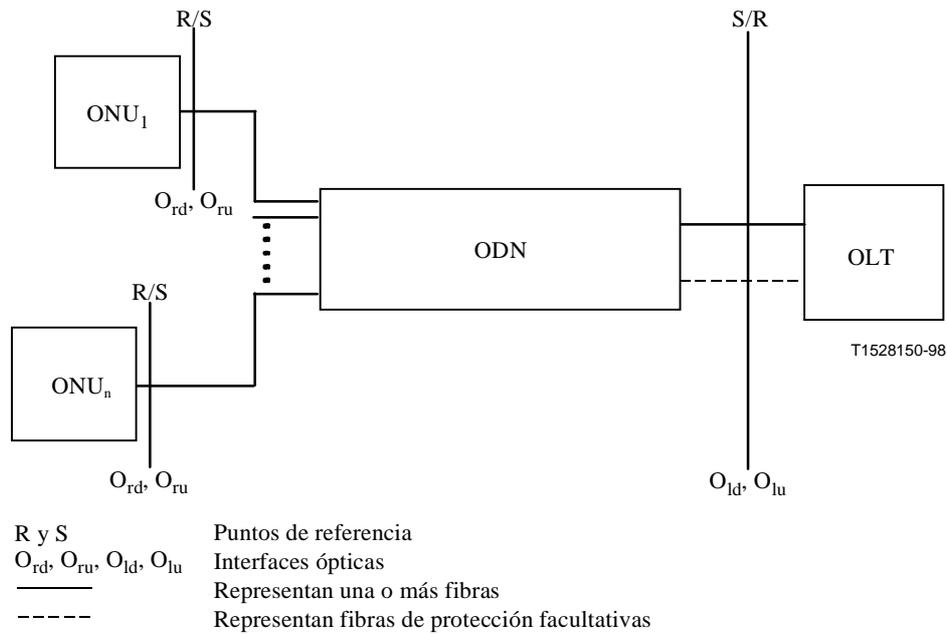
**Figura 5/G.983.1 – Configuración física genérica de la red de distribución óptica**
