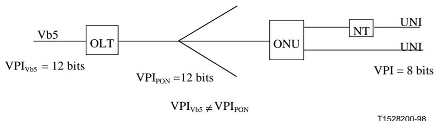
**Figura 10/G.983.1 – Utilización de VP en la PON**
