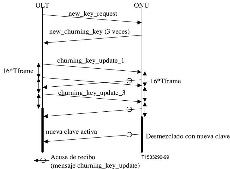
Figura 17/G.983.1 – Flujo de mensajes de mezclado
