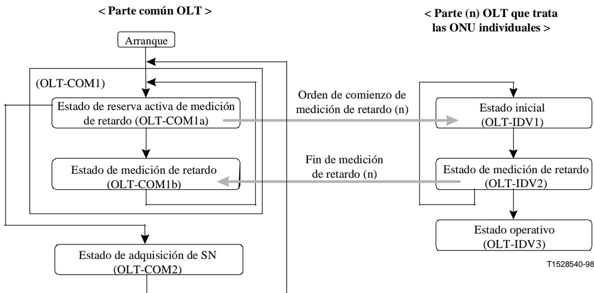
**Figura III.2/G.983.1 – Flujo de determinación de distancia [OLT] (ejemplo)**
