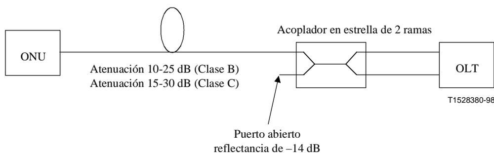
**Figura I.1/G.983.1 – Efecto de conectores abiertos situados en el lado ONU del acoplador en estrella**
