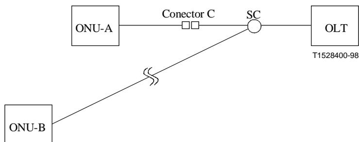
**Figura I.3/G.983.1 – Efecto de desconectar un conector cerca de ONU**
