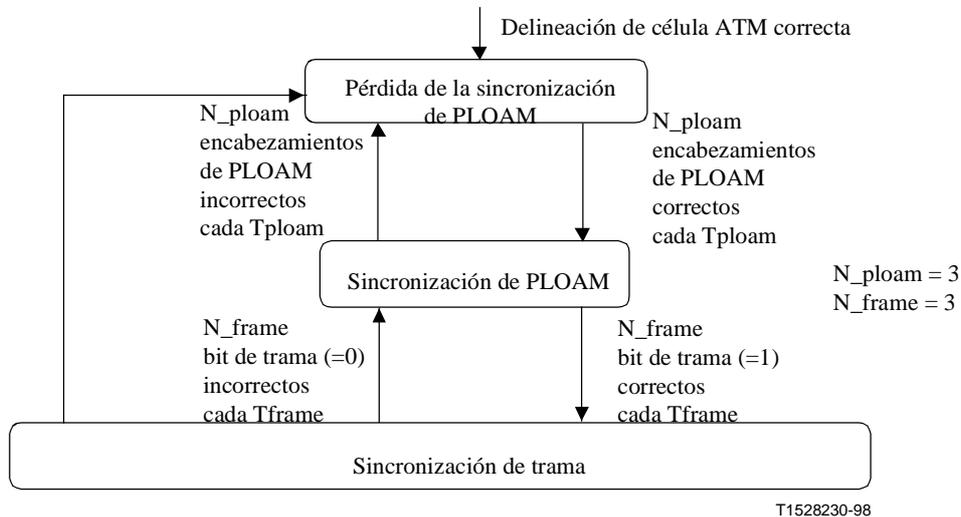
**Figura 13/G.983.1 – Flujo de la sincronización de trama**
