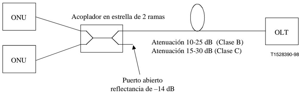
**Figura I.2/G.983.1 – Efecto de conectores abiertos situados en el lado OLT del acoplador en estrella**
