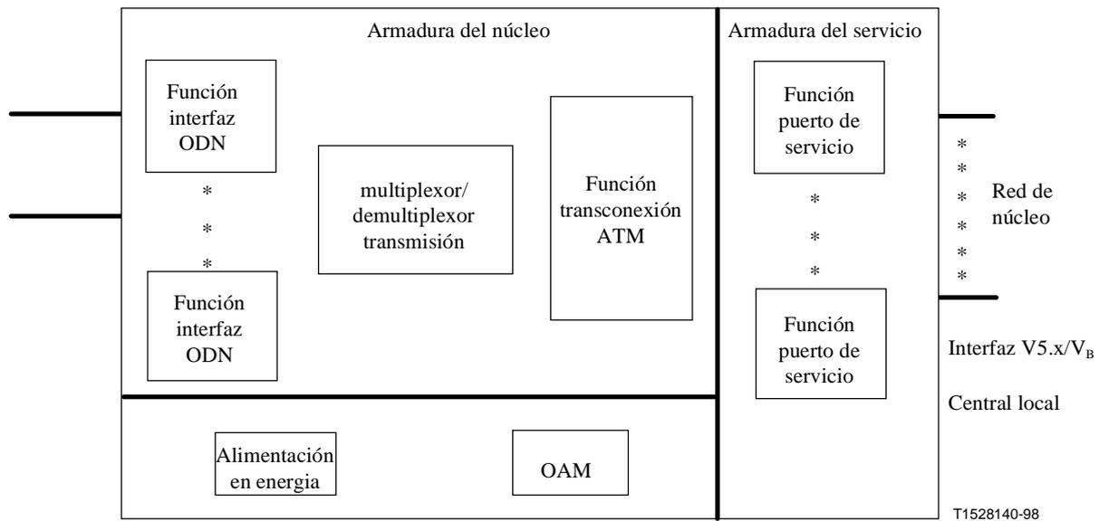
**Figura 4/G.983.1 – Ejemplo de bloques funcionales OLT**
