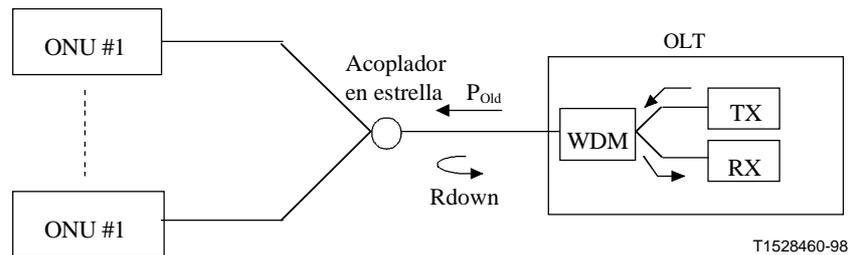
Figura II.5/G.983.1 – Modelo 3 para incidencia en receptor OLT
