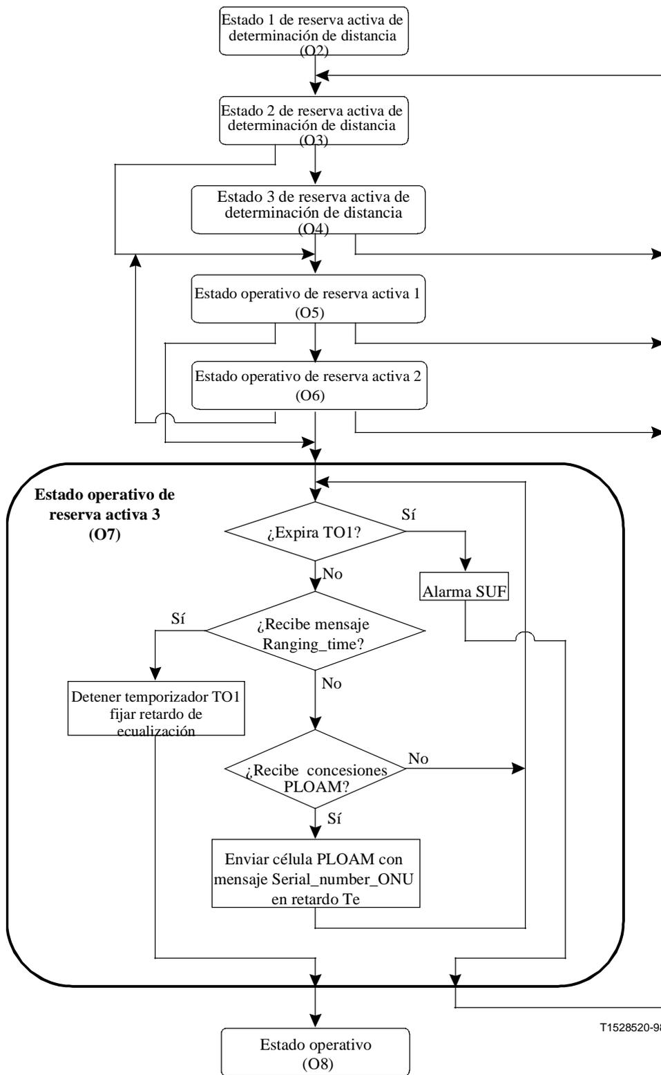
**Figura III.1/G.983.1 – Flujo de determinación de distancia [ONU] (ejemplo)**
