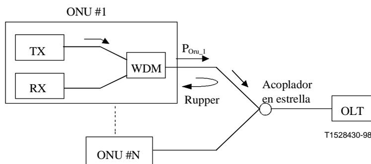
Figura II.2/G.983.1 – Modelo para incidencia en receptor ONU
