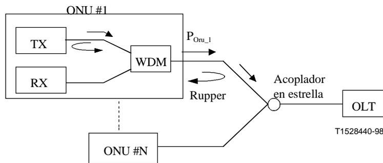
**Figura II.3/G.983.1 – Modelo 1 para incidencia en receptor OLT**
