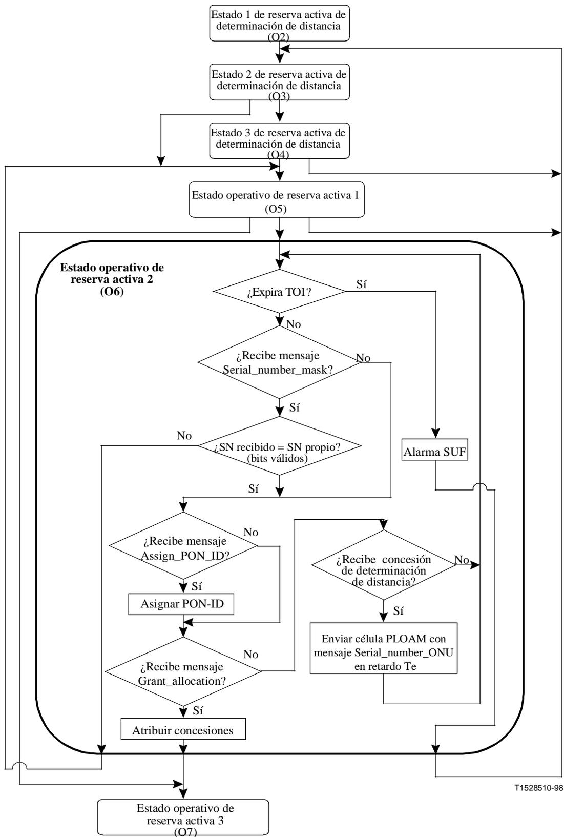
**Figura III.1/G.983.1 – Flujo de determinación de distancia [ONU] (ejemplo)**
