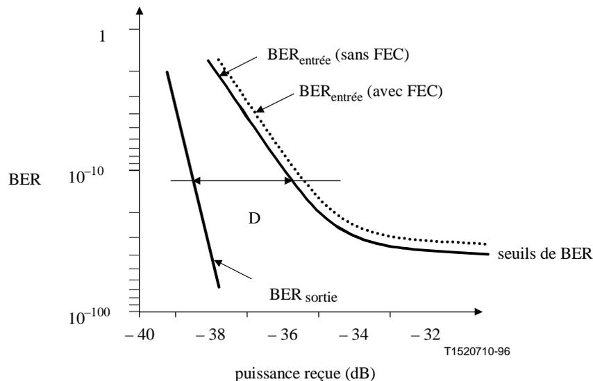
**Figure 7/G.975 – Système d'évaluation du gain de codage (D)**
