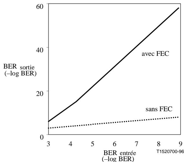
Figure 6/G.975 – BER de sortie théorique en fonction du BER d'entrée théorique
