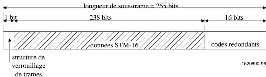
Figure 5/G.975 – Contenu des sous-trames de la trame FEC
