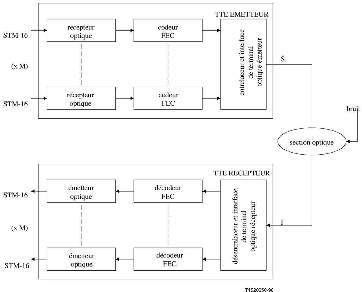
**Figure 1/G.975 – Schéma d'un système sous-marin utilisant une fonction FEC**
