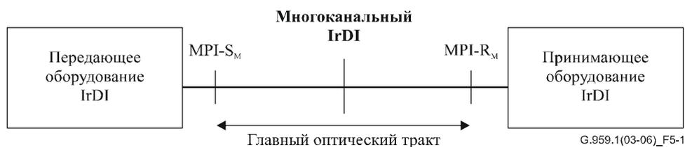
**Рисунок 5-1/G.959.1 – Многоканальная эталонная конфигурация IrDI**
