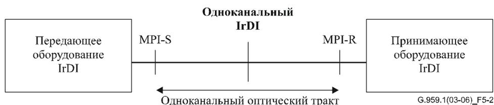
**Рисунок 5-2/G.959.1 – Одноканальная эталонная конфигурация IrDI**
