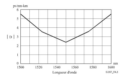
Figure A.3/G.957 – Valeurs absolues maximales, | D |, du coefficient de dispersion pour les fibres conformes à la Rec. UIT-T G.653
