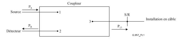
Figure I.1/G.957 – Montage du coupleur pour un OTDR et un OCWR
