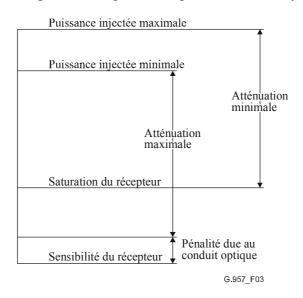
Figure 3/G.957 – Liaison entre les paramètres optiques
