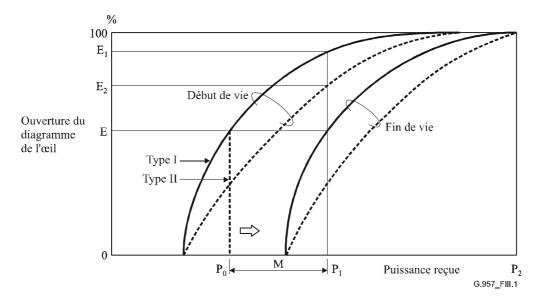
Figure III.1/G.957 – Caractéristiques du diagramme de l'œil
