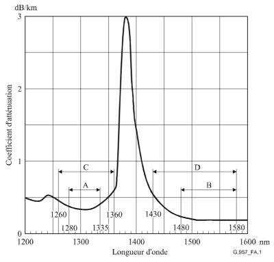
Les gammes A et B sont adaptées aux applications à longue portée (L-N.x), et les gammes C et D sont adaptées aux applications à courte portée (S-N.x) et intrastations (I-N).
