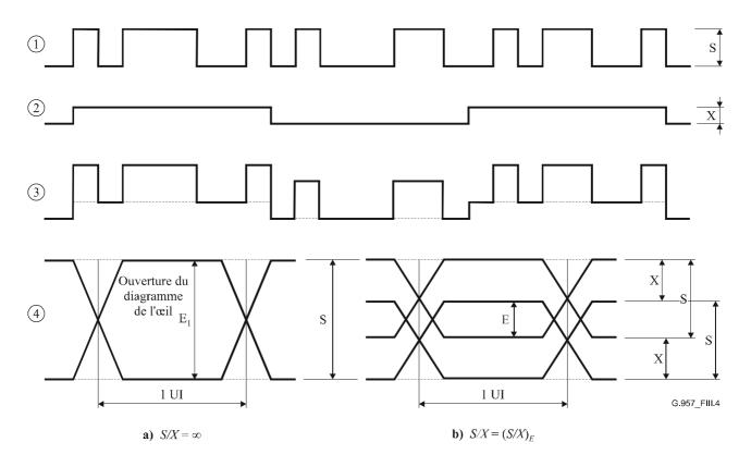
Figure III.4/G.957 – Configuration de mesure de S/X
