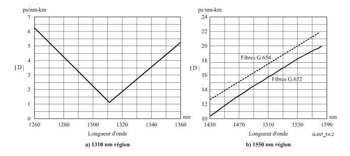
Figure A.2/G.957 – Valeur absolue maximale, | D |, du coefficient de dispersion pour les fibres conformes à la Rec. UIT-T G.652 (—) et à la Rec. UIT-T G.654 (----)
