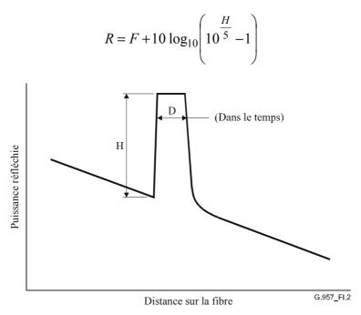
Figure I.2/G.957 – Trace de l'OTDR pour un réflecteur isolé
