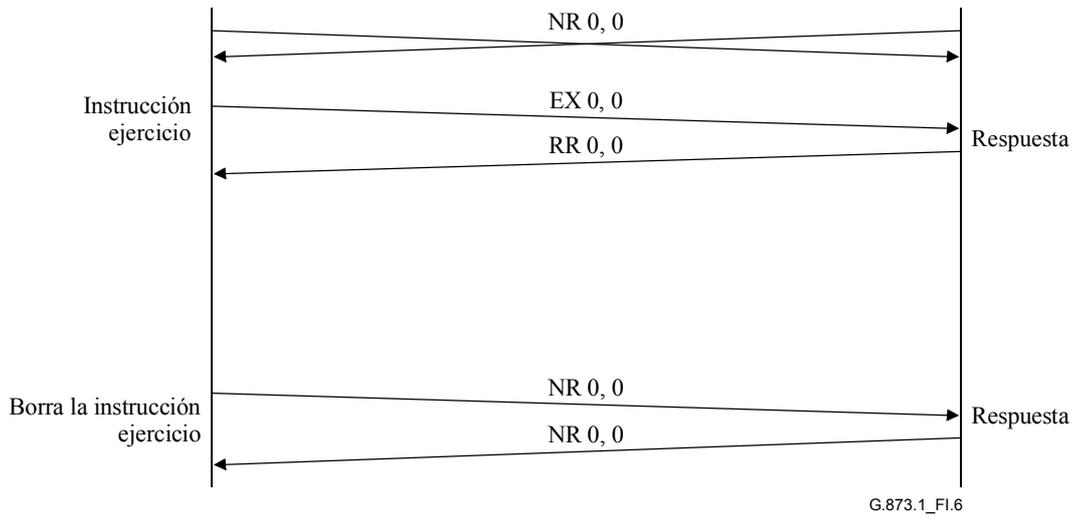
**Figura I.6/G.873.1 – Ejemplo de la instrucción ejercicio partiendo del estado NR 1:n sin tráfico adicional**
