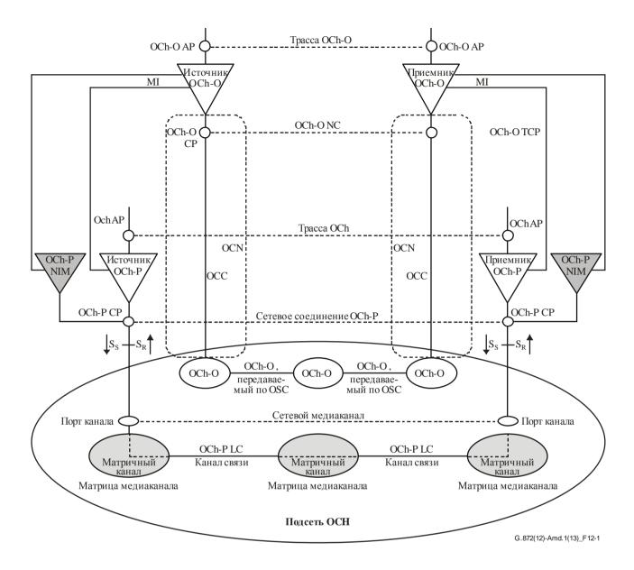
ПРИМЕЧАНИЕ. —  $S_s$  и  $R_s$  на рисунке 12-1 обозначают эталонные точки, определенные в [ITU-T G.698.1] и [ITU-T G.698.2].
