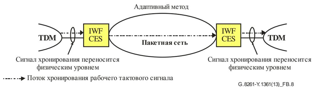
**Рисунок В.8 – Пример восстановления хронирования на основе адаптивного метода**
