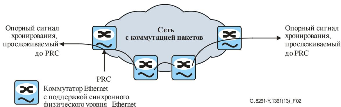
**Рисунок 2 – Пример сети синхронизации ведущий–ведомый поверх синхронного Ethernet**
