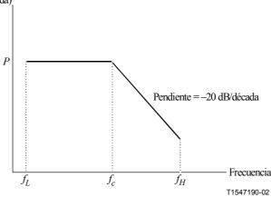
Figura A.1/G.8251 – Transferencia de fluctuación de fase del ODCb
