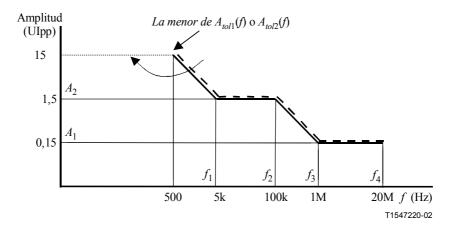
Figura I.3/G.8251 – Límite superior de la fluctuación de fase sinusoidal a la salida en una interfaz de OTU1 [la menor de  $A_{tol1}(f)$  o  $A_{tol2}(f)$ ] comparada con la máscara de tolerancia a la fluctuación de fase/fluctuación lenta de fase a la entrada
