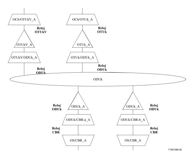
Figura VI.1/G.8251 – Funciones atómicas utilizadas para la temporización de la OTN
