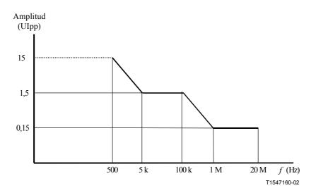
Figura 1/G.8251 – Límite de la tolerancia a la fluctuación de fase sinusoidal a la entrada de OTU1
