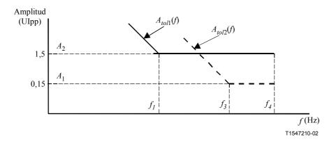
Figura I.2/G.8251 – Límites superiores de la amplitud de la fluctuación de fase sinusoidal
