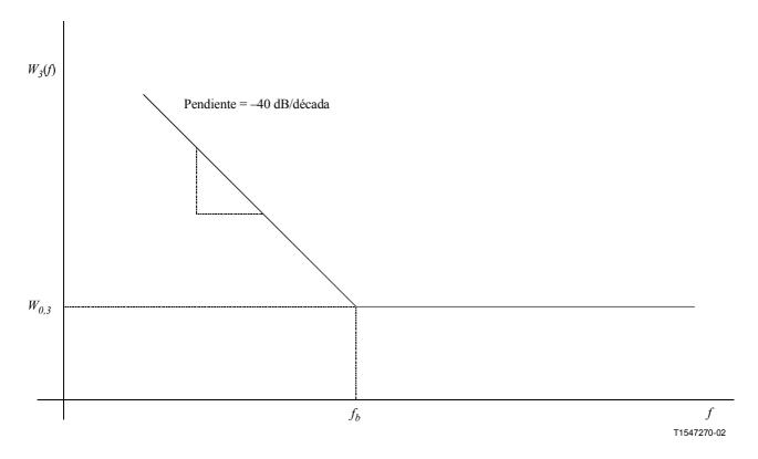
Figura IV.2-2/G.8251 – Representación esquemática de la densidad espectral de potencia de un VCO
