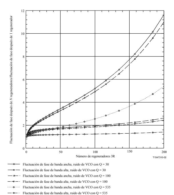
NOTA – Las hipótesis establecidas son: las anchuras de banda del regenerador 3R cumplen los requisitos G.783 (SDH), acumulación de fluctuación de fase aleatoria, ruido de VCO (paso alto) con WFM y WPM y factor *Q* indicado. Trazado lineal.
