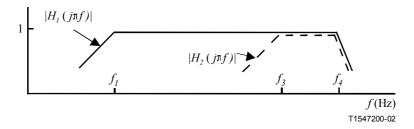
Figura I.1/G.8251 – Límites superiores de la amplitud de la fluctuación de fase sinusoidal
