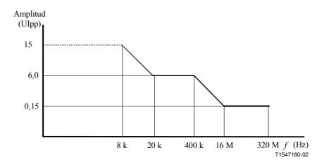
Figura 3/G.8251 – Límite de la tolerancia a la fluctuación de fase sinusoidal a la entrada de OTU3
