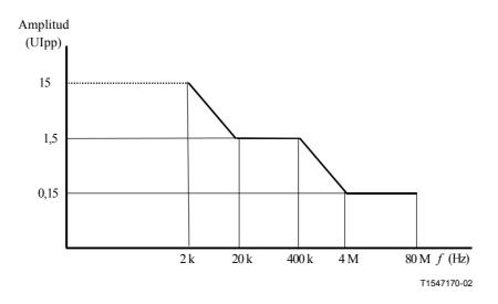
Figura 2/G.8251 – Límite de la tolerancia a la fluctuación de fase sinusoidal de OTU2
