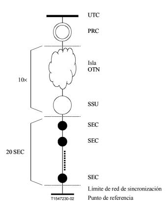
Figura II.1/G.8251 – Cadena de referencia de sincronización adaptada (provisional)
