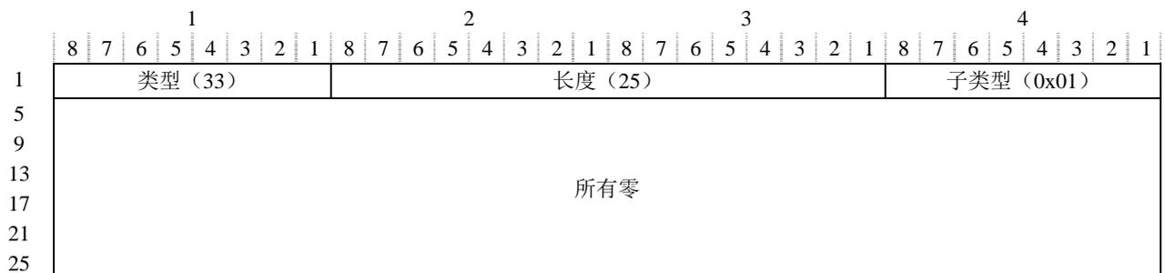
图8-9 — 目标MEP/MIP ID TLV格式（发现出口MEP/MIP）
