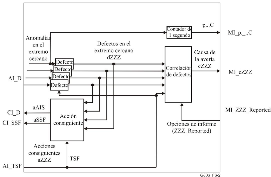
**Figura 6-2/G.806 – Proceso de supervisión dentro de las funciones de adaptación**
