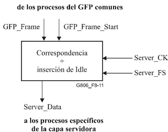
**Figura 8-11/G.806 – Procesos fuente del GFP específicos de la capa servidora**
