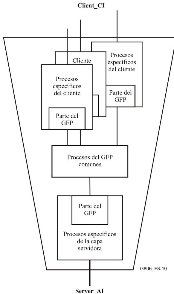
**Figura 8-10/G.806 – Bloques genéricos de adaptación servidor/cliente basados en el GFP**
