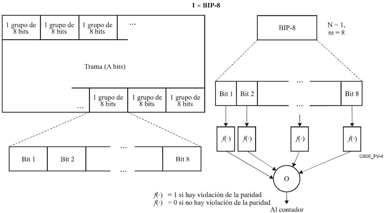
**Figura V.4/G.806 – Ilustración de la utilización del EDC 1 × BIP-8**
