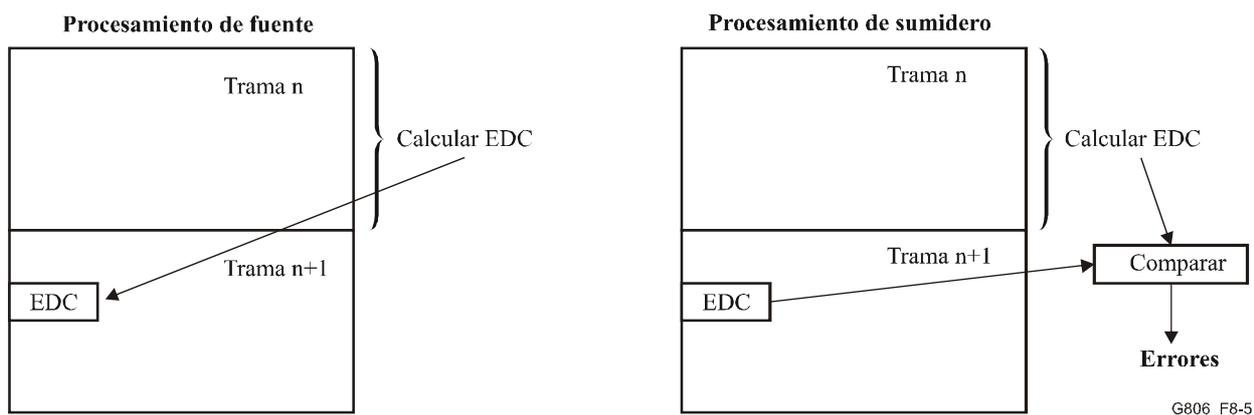
**Figura 8-5/G.806 – Ejemplo de supervisión de la calidad de la señal basada en la signatura**
