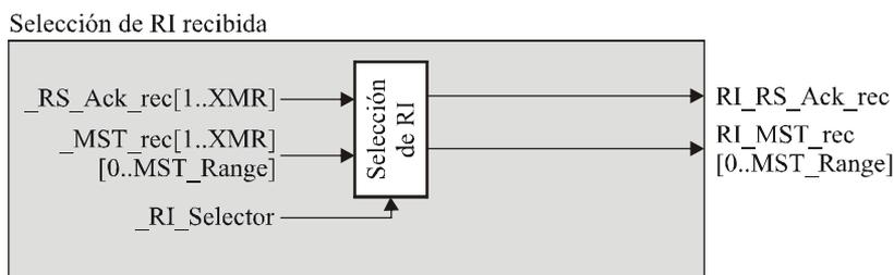
NOTA 1 – Las entradas internas `_RS_Ack_rec[k]`, `_MST_rec[k]` se originan en el proceso "Desensamblado de VLI", "`_RI_Selector`" en el "Bloque LCAS".
