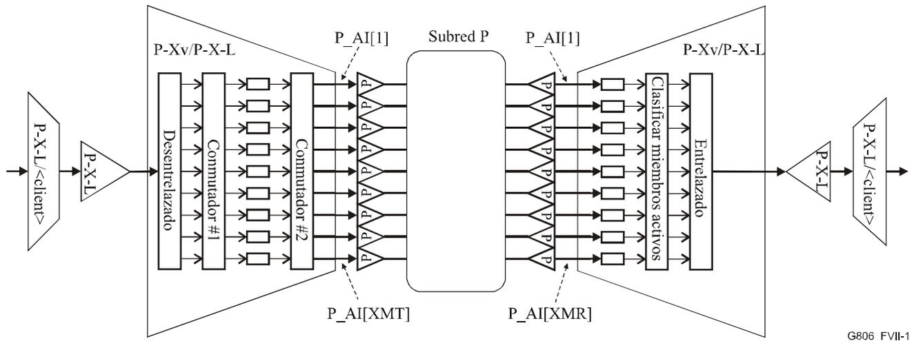
Figura VII.1/G.806 – Configuración básica
