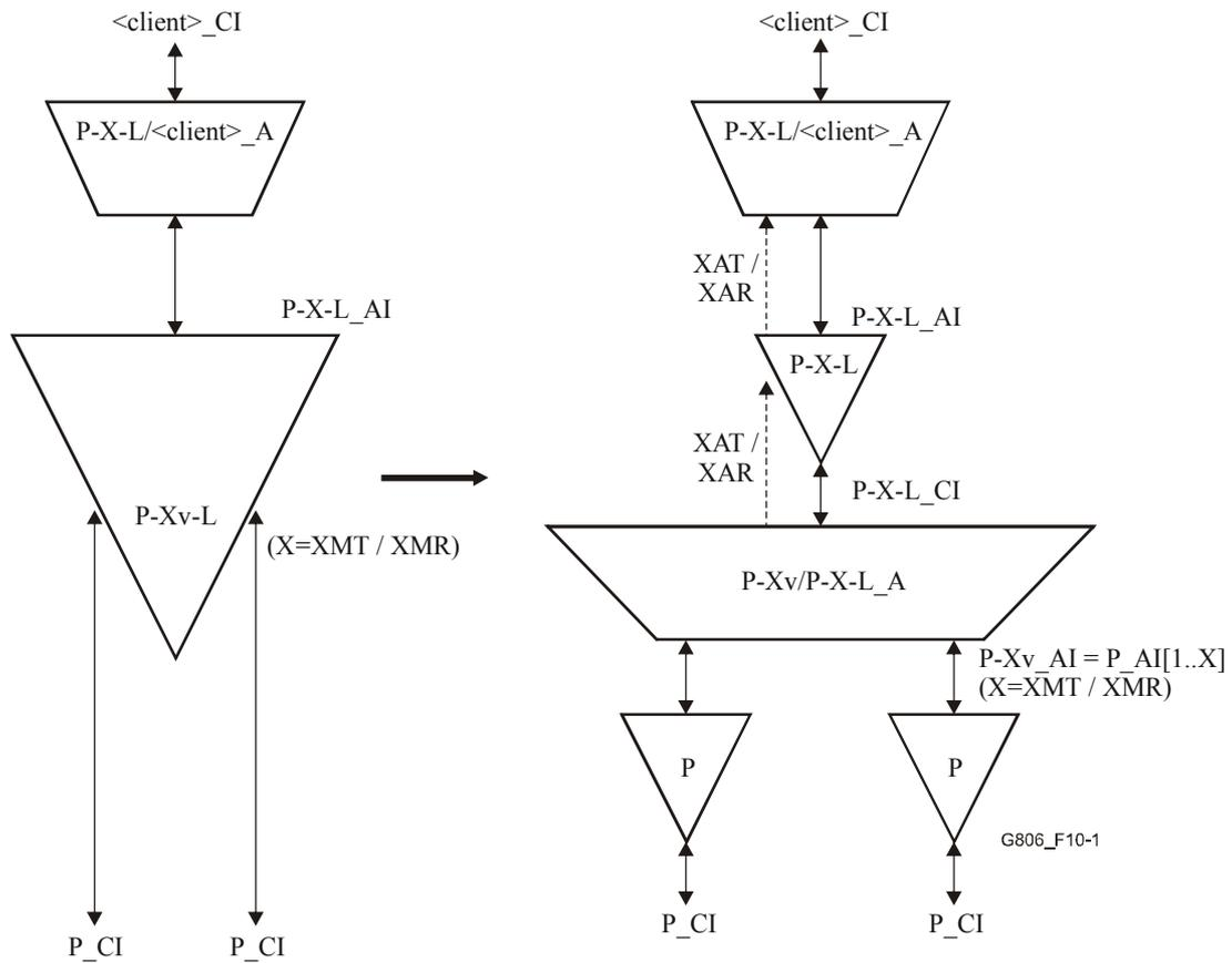
**Figura 10-1/G.806 – Descomposición de la función P-Xv-L\_TT**
