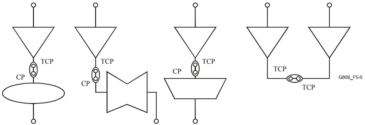
**Figura 5-9/G.806 – Vinculación que incluye puntos de conexión de terminación (vinculación TCP-CP y TCP-TCP)**
