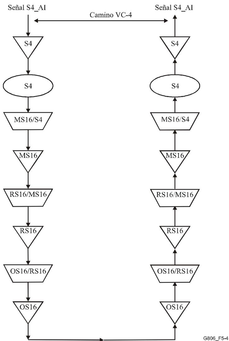
**Figura 5-4/G.806 – Ejemplo de trayecto VC-4 unidireccional en una red SDH**
