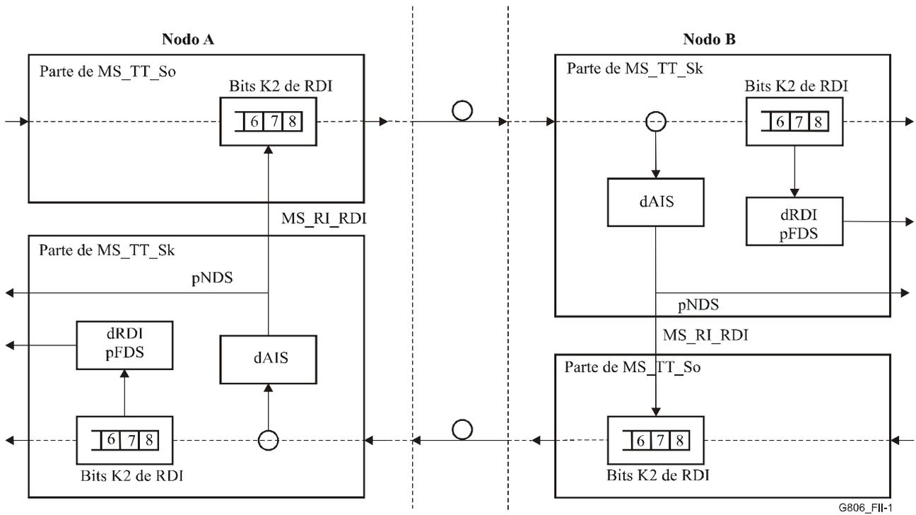
**Figura II.1/G.806 – Ejemplo de control de inserción de RDI (sección múltiplex)**
