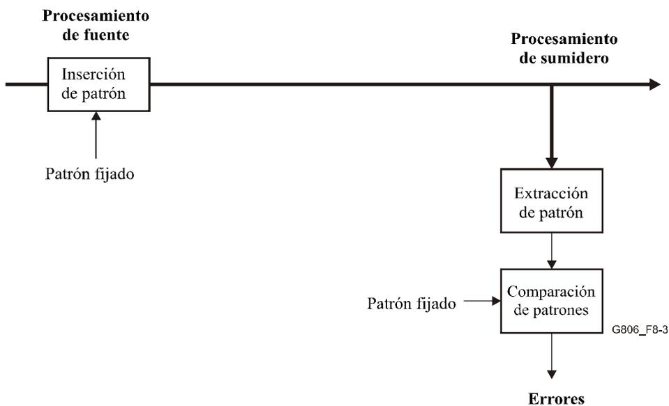
**Figura 8-3/G.806 – Supervisión de la calidad de la señal basada en un patrón**
