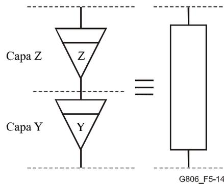
**Figura 5-14/G.806 – Función compuesta que se extiende a múltiples capas**
