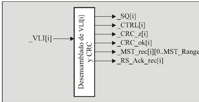
NOTA 1 – La entrada interna \_VLI[i] se origina en el proceso de "Extracción de TSx, VLI".
