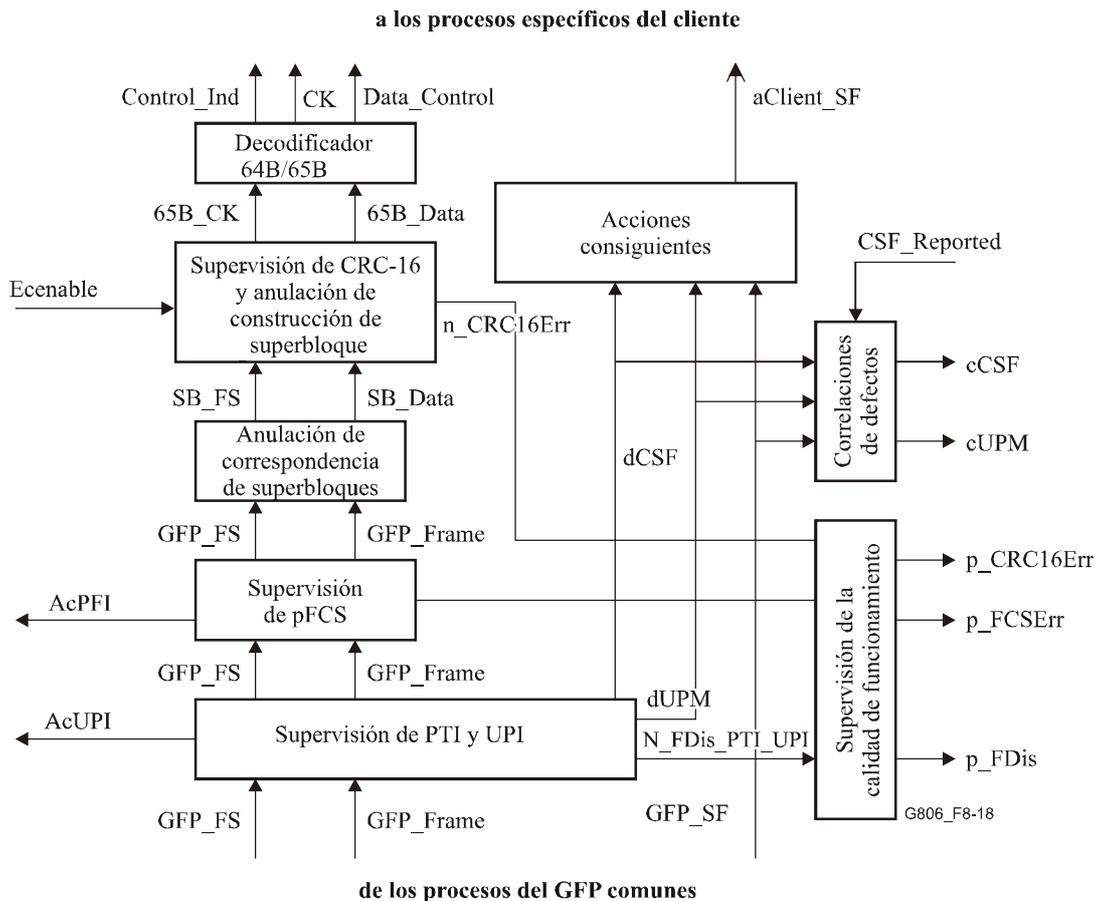
**Figura 8-18/G.806 – Procesos sumidero del GFP-T específicos del cliente**
