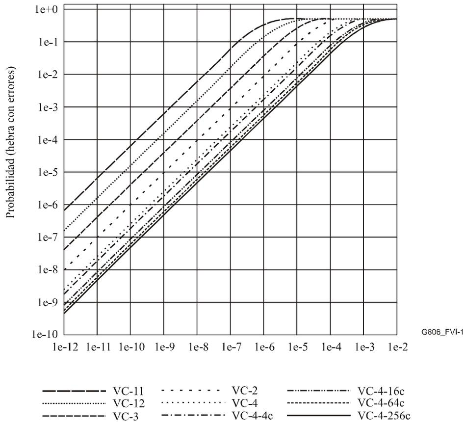
**Figura VI.1/G.806 – Probabilidad de hebra con errores en función de la BER media, suponiendo errores aleatorios (distribución de Poisson)**
