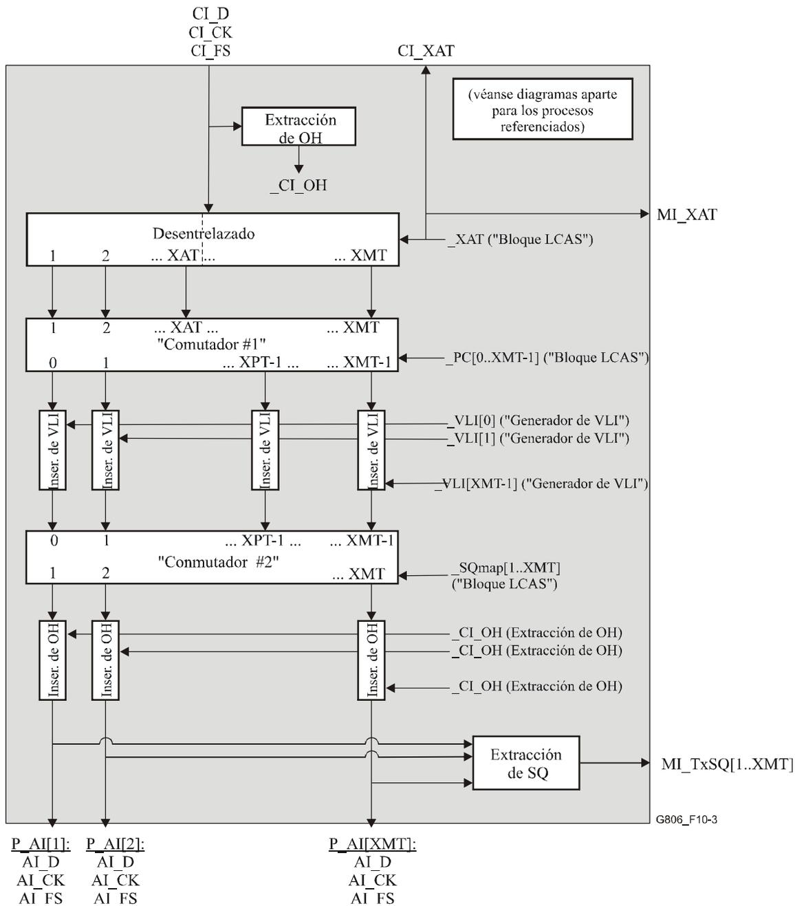
**Figura 10-3/G.806 – Procesos de P-Xv/P-X-L\_A\_So (diagrama principal)**
