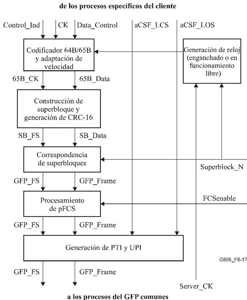
**Figura 8-17/G.806 – Procesos fuente del GFP-T específicos del cliente**
