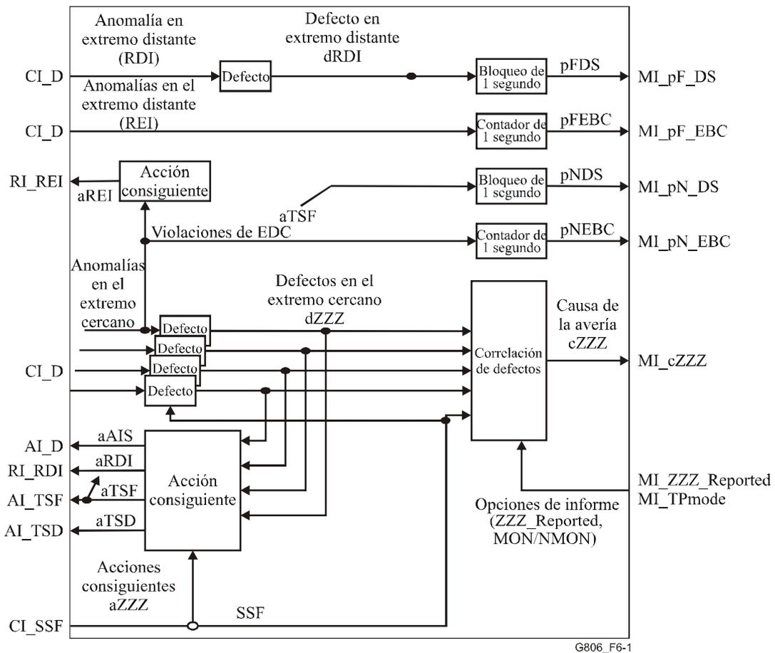
**Figura 6-1/G.806 – Proceso de supervisión dentro de las funciones de terminación de camino**
