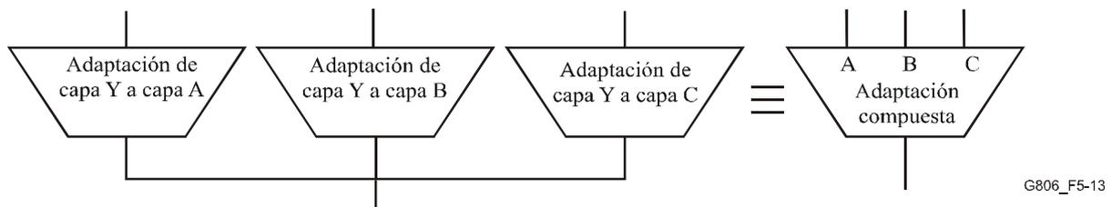
**Figura 5-13 /G.806 – Función de adaptación compuesta**
