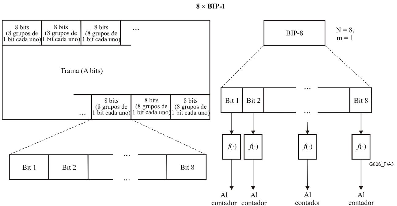
**Figura V.3/G.806 – Ilustración de la utilización del EDC  $8 \times \text{BIP-1}$**
