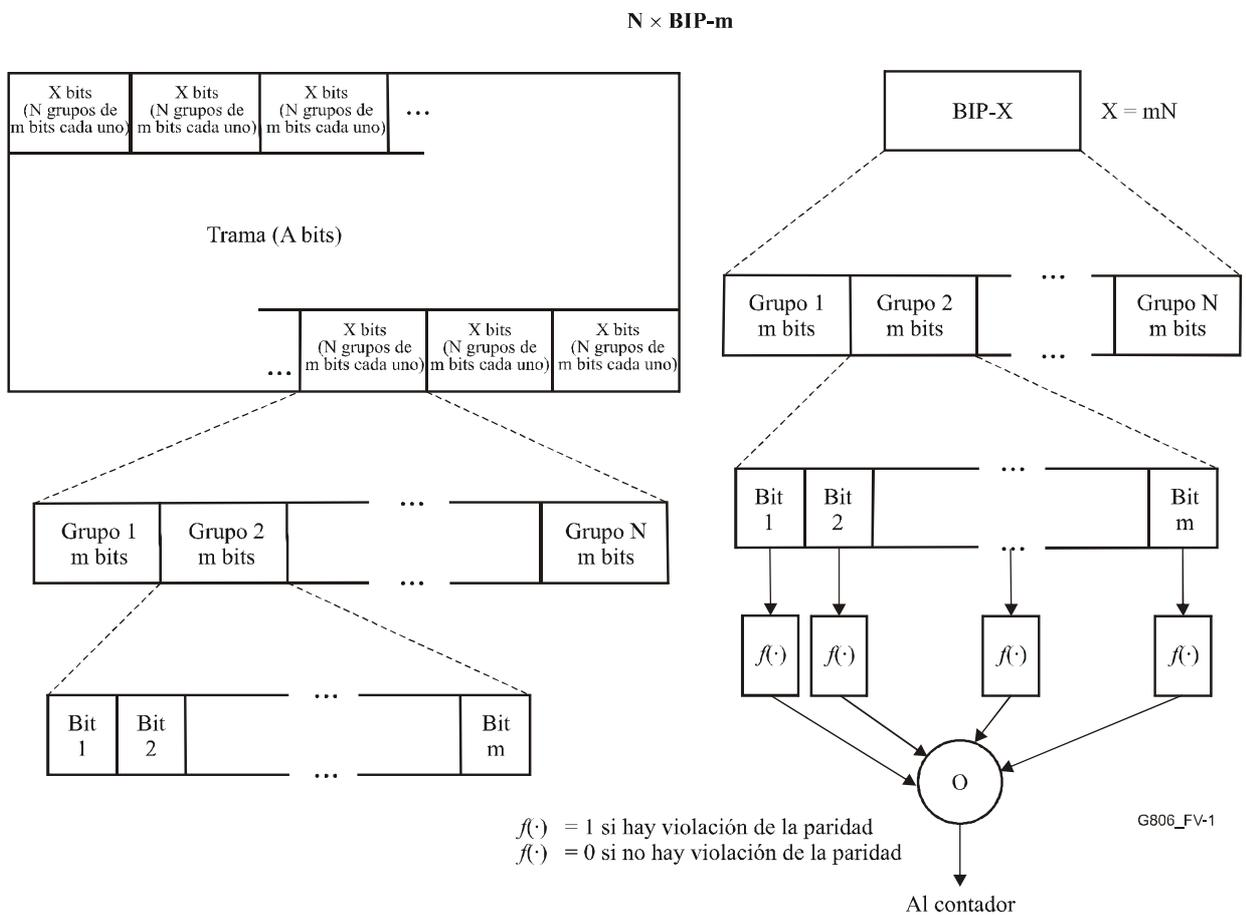
**Figura V.1/G.806 – Ilustración de la utilización del EDC  $N \times \text{BIP-}m$**
