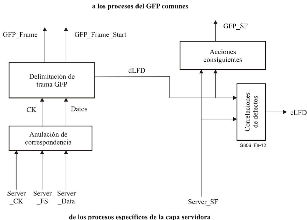
**Figura 8-12/G.806 – Procesos sumidero del GFP específicos de la capa servidora**
