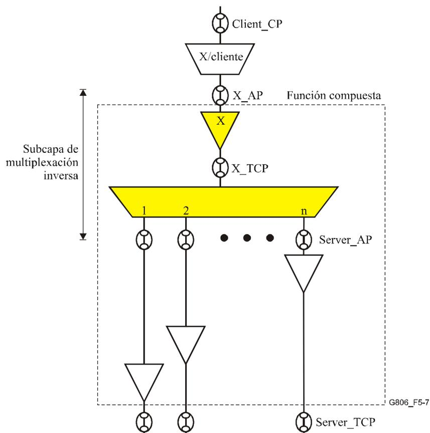
**Figura 5-7/G.806 – Multiplexación inversa**
