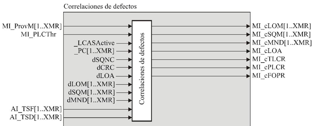
NOTA 2 – Las entradas internas `_LCASActive`, `_PC`, `dSQNC`, `dCRC`, `dSQM[k]` se originan en el "Bloque LCAS", `dLOM[k]` en el proceso "Extracción de MFI", `dMND[k]`, `dLOA` en el proceso "Cálculo del retardo".
