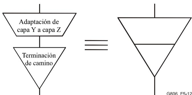
**Figura 5-12/G.806 – Función de terminación/adaptación compuesta**
