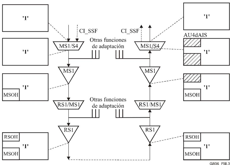
**Figura III.3/G.806 – Generación de la señal todos UNOS (AIS) en la fuente y detección en el sentido hacia el sumidero**
