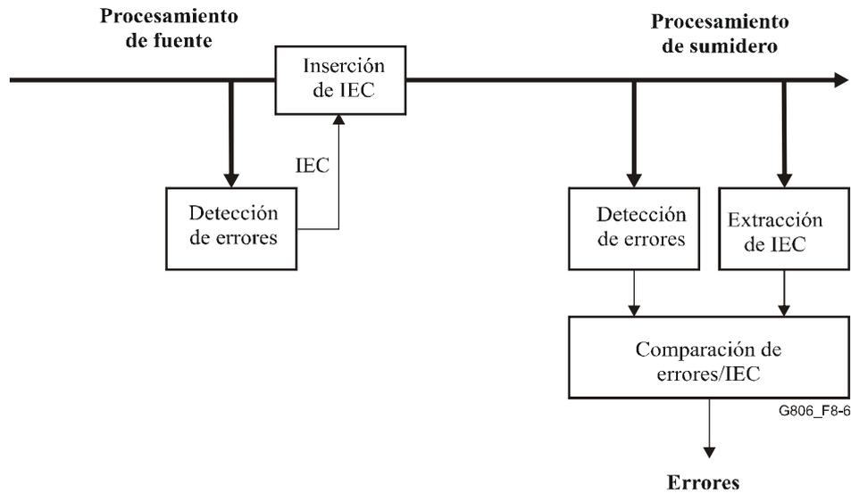
**Figura 8-6/G.806 – Supervisión de la calidad de la señal basada en el IEC**
