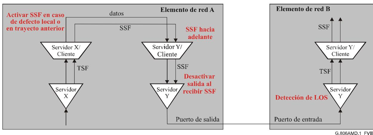
Figura VIII.1/G.806 – Ejemplo de "desactivación de la salida"
