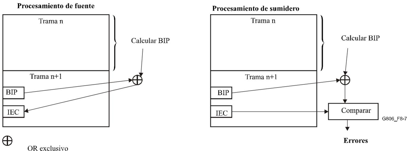
**Figura 8-7/G.806 – Ejemplo de supervisión de la calidad de la señal basada en el IEC**
