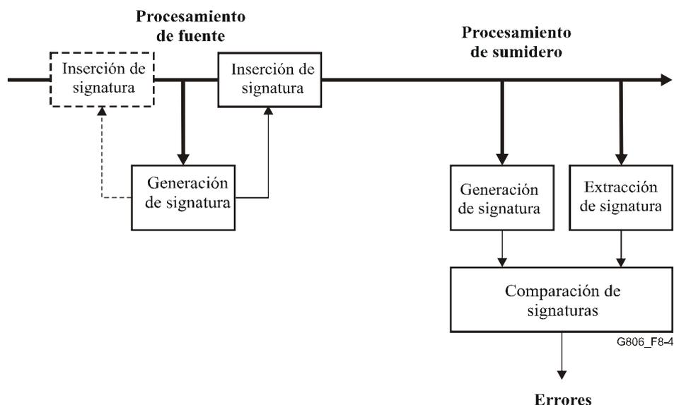
**Figura 8-4/G.806 – Supervisión de la calidad de la señal basada en la signatura**
