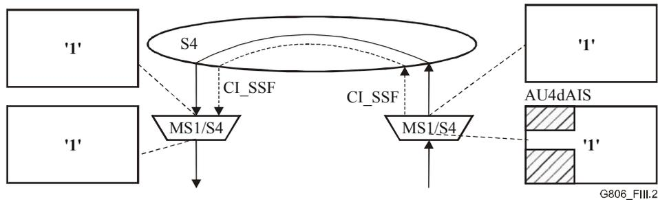
**Figura III.2/G.806 – Propagación de la señal todos UNOS en el sentido de sumidero a fuente**
