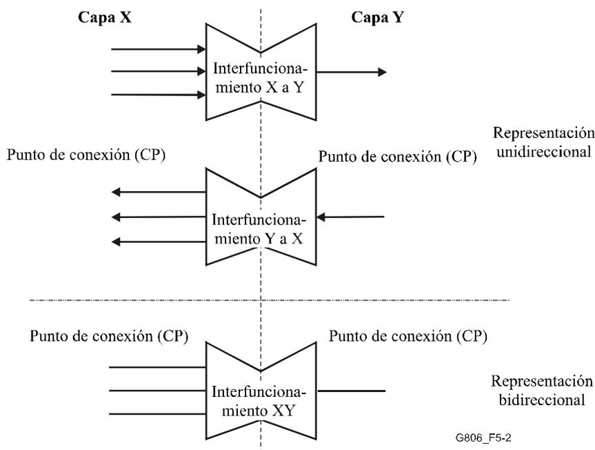
**Figura 5-2/G.806 – Función de interfuncionamiento de redes de capa**
