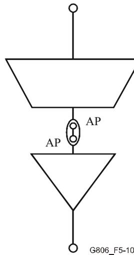
**Figura 5-10/G.806 – Vinculación de puntos de acceso (vinculación AP-AP)**
