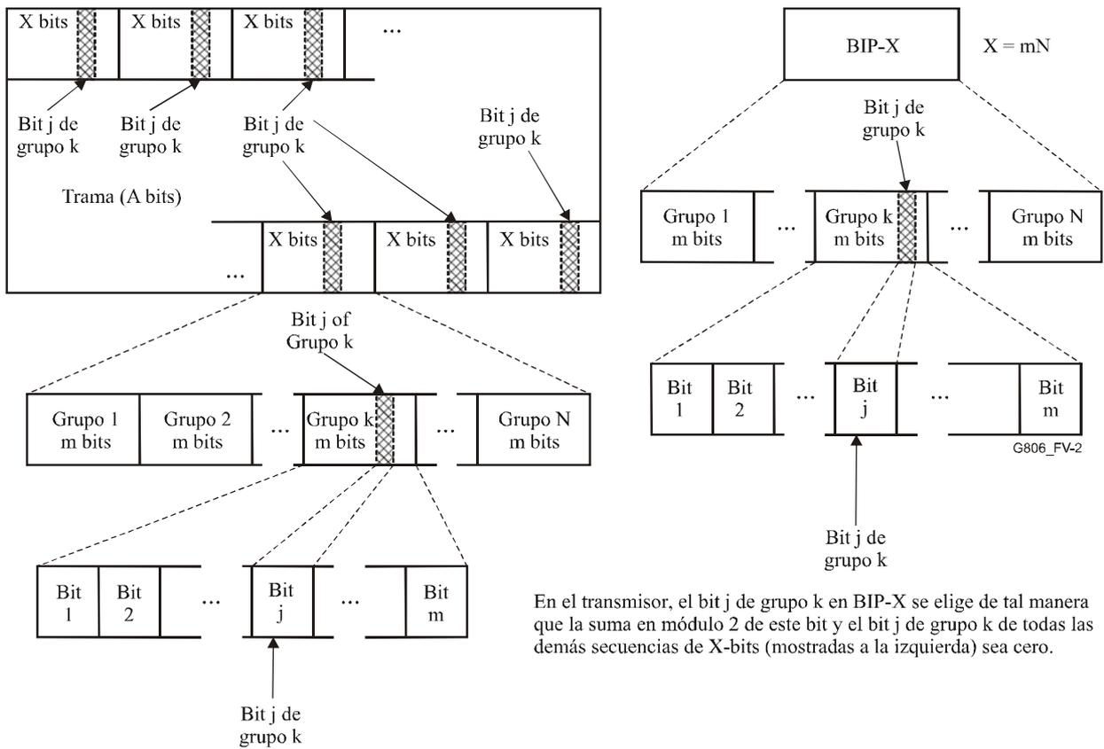
**Figura V.2/G.806 – Ilustración del cálculo de BIP- $X$  y la utilización del EDC  $N \times \text{BIP-m}$ , mostrando que el cálculo de BIP- $X$  en el transmisor es independiente de  $m$  y  $N$**
