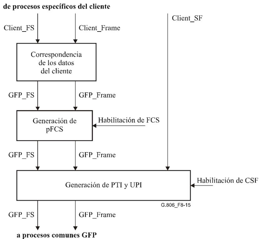
**Figura 8-15/G.806 – Procesos de fuente GFP-F específicos del cliente**
