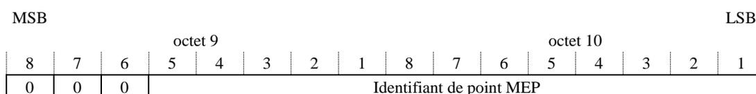
**Figure 9.2-3 – Format d'identifiant de point MEP dans l'unité PDU de message CCM**
