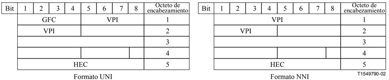
**Figura 14-26/G.798 – Información de encabezamiento de célula procesada en ODUkP/VP\_A\_So**
