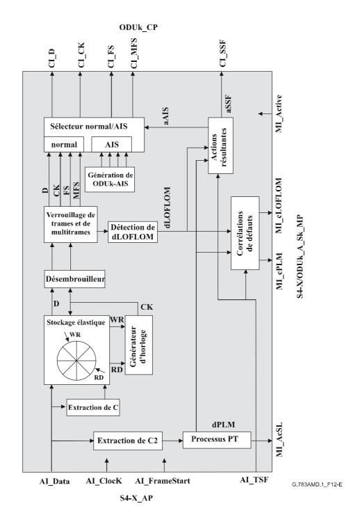
Figure 12-E/G.783 – Processus de la fonction S4-X/ODUk A Sk
