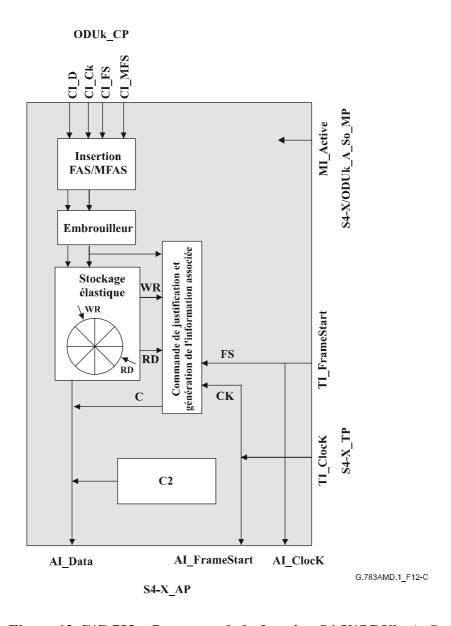
Figure 12-C/G.783 – Processus de la fonction S4-X/ODUk\_A\_So
