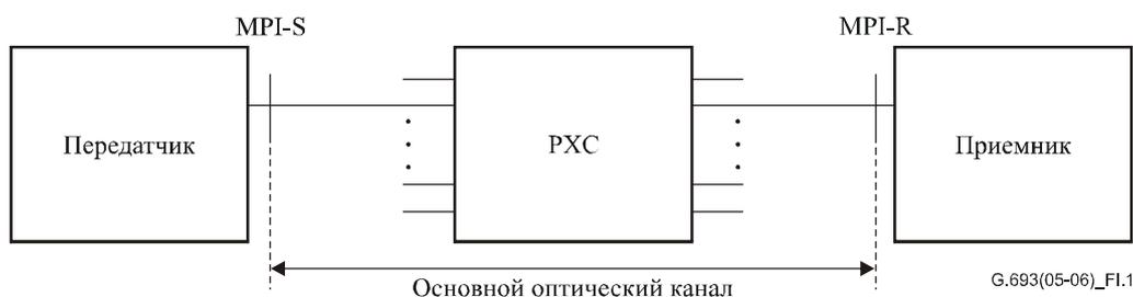
**Рисунок I.1/G.693 – Пример оптического звена связи, показывающий использование пассивных фотонных кросс-коммутаторов между MPI-S и MPI-R**
