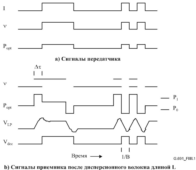
**Рисунок III.1/G.691 – Принцип передачи с поддержкой дисперсии;
