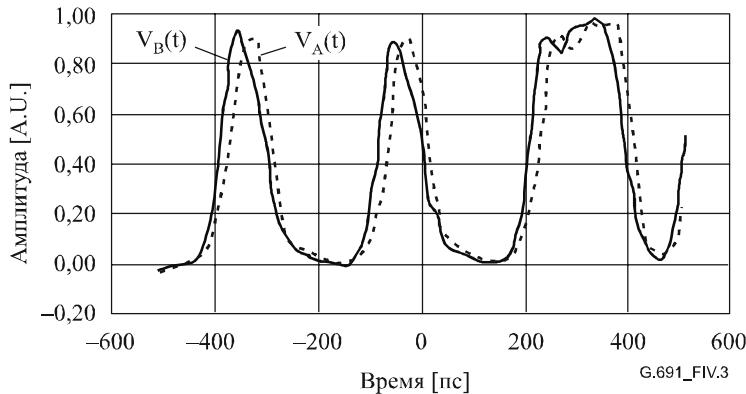
**Рисунок IV.3/G.691 – Характеристики данных сигнала PRBS со 10 Гбит/с, измеренные при помощи интерферометра, настроенного на квадратурные точки А и В, соответственно**
