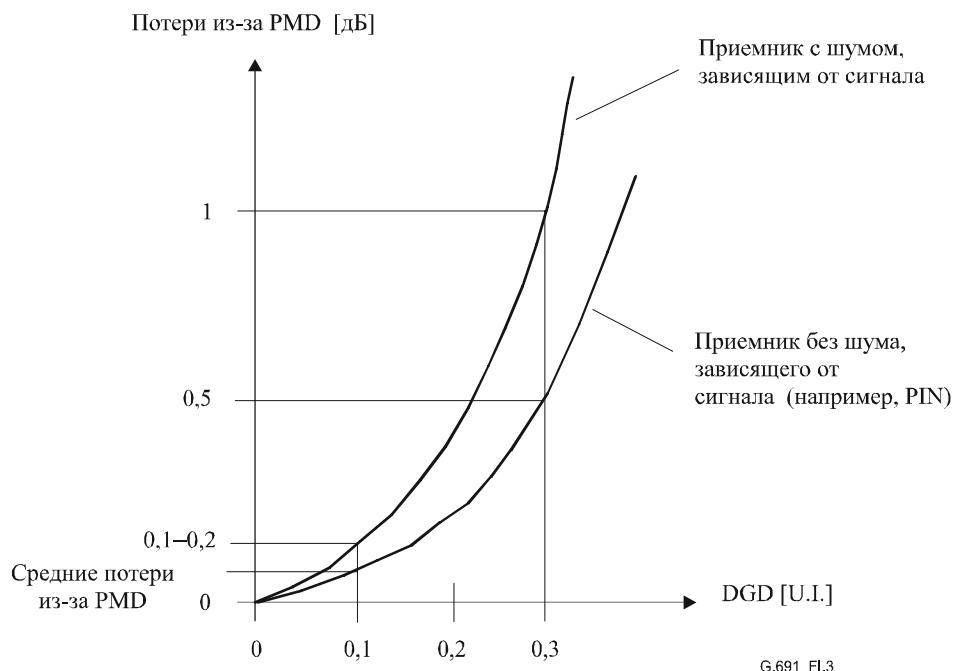
**Рисунок I.3/G.691 – Зависимость ухудшения качества работы приемника от реальных значений ДГВЗ (иллюстрация)**
