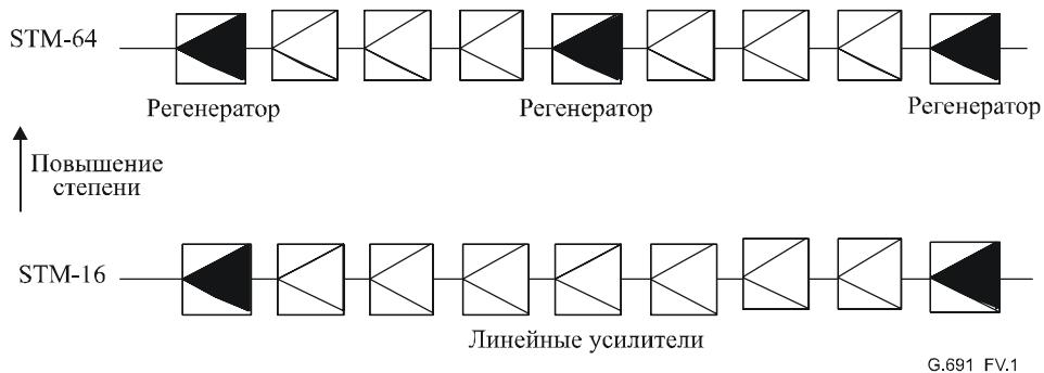
**Рисунок V.1/G.691 – Пример модернизации системы STM-16 до уровня STM-64**
