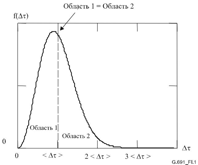
**Рисунок I.1/G.691 – Функция распределения Максвелла (иллюстрация) –
