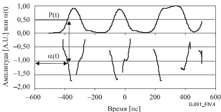
**Рисунок IV.4/G.691 – График результатов расчета  $P(t)$  и  $\alpha(t)$ ;**
