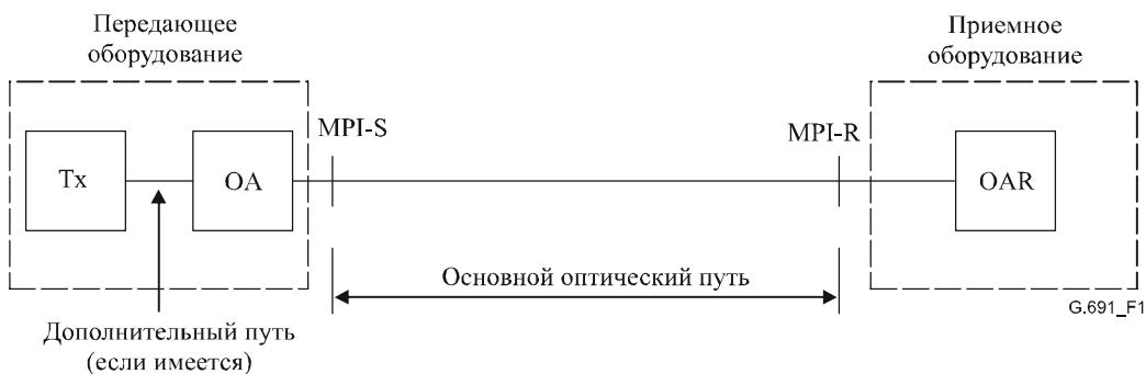
**Рисунок 1/G.691 – Пример оптической линии, на котором показаны точки интерфейсов, определенных в настоящей Рекомендации**
