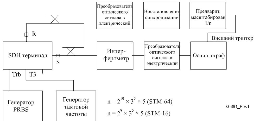
**Рисунок IV.1/G.691 – Измерительная установка**
