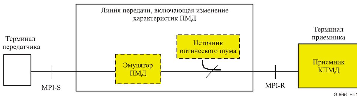
Рисунок I.1/G.666 – Общая схема для измерения параметров приемников с КПМД
