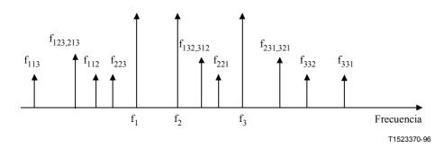
Figura II.3-4/G.663 – Productos generados por la mezcla de cuatro ondas de tres señales
