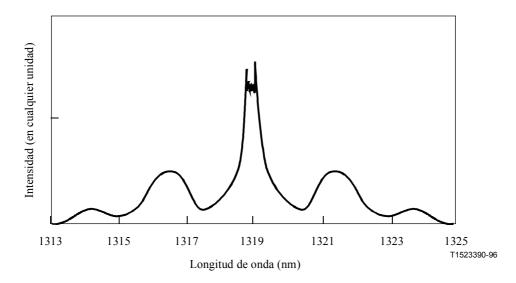
Figura II.3-2/G.663 – Espectro de potencia de un impulso tras una propagación a lo largo de una fibra de 1 km (anchura de impulso de entrada: 100 ps, potencia de punta: 7 W).
