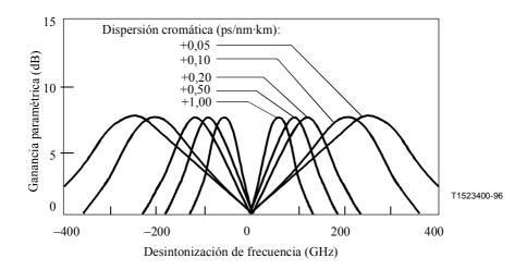
Figura II.3-3/G.663 – Característica de ganancia MI calculada – desintonización de frecuencia, de fibras de 30 km de largo (pérdida de 0,24 dB/km), con cinco valores diferentes del coeficiente de dispersión, para una potencia inyectada de señal CW de +16 dBm
