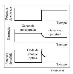
Figura II.6-1/G.663 – Ejemplo de generación de una onda de choque óptica
