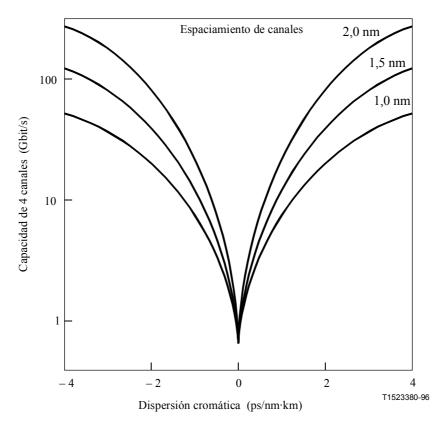
Figura II.3-5/G.663 – Influencia de la dispersión en la capacidad del sistema en presencia de FWM
