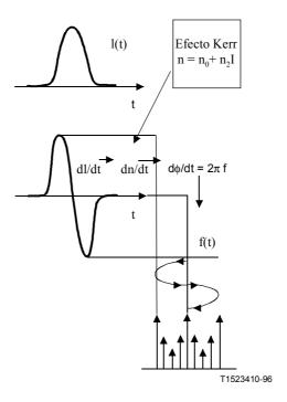
Figura II.3-1/G.663 – Mecanismo de ensanchamiento espectral debido a automodulación de fase
