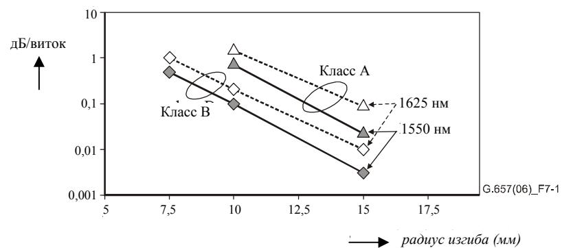
**Рисунок 7-1 – Потери на макроизгибе по данным таблиц 7-1 и 7-2 для классов А и В**
