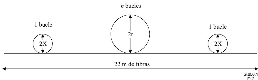
**Figura 12/G.650.1 – Condición de instalación para la medición de  $\lambda_{cc}$  en fibras sin cablear**
