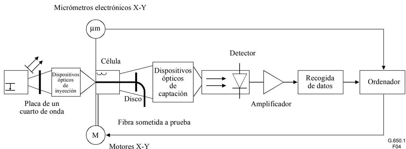
**Figura 4/G.650.1 – Configuración de prueba típica de la técnica de campo próximo refractado**
