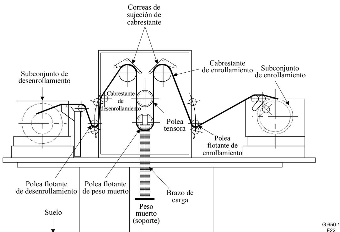
**Figura 22/G.650.1 – Máquina de prueba mecánica de recepción de peso muerto**
