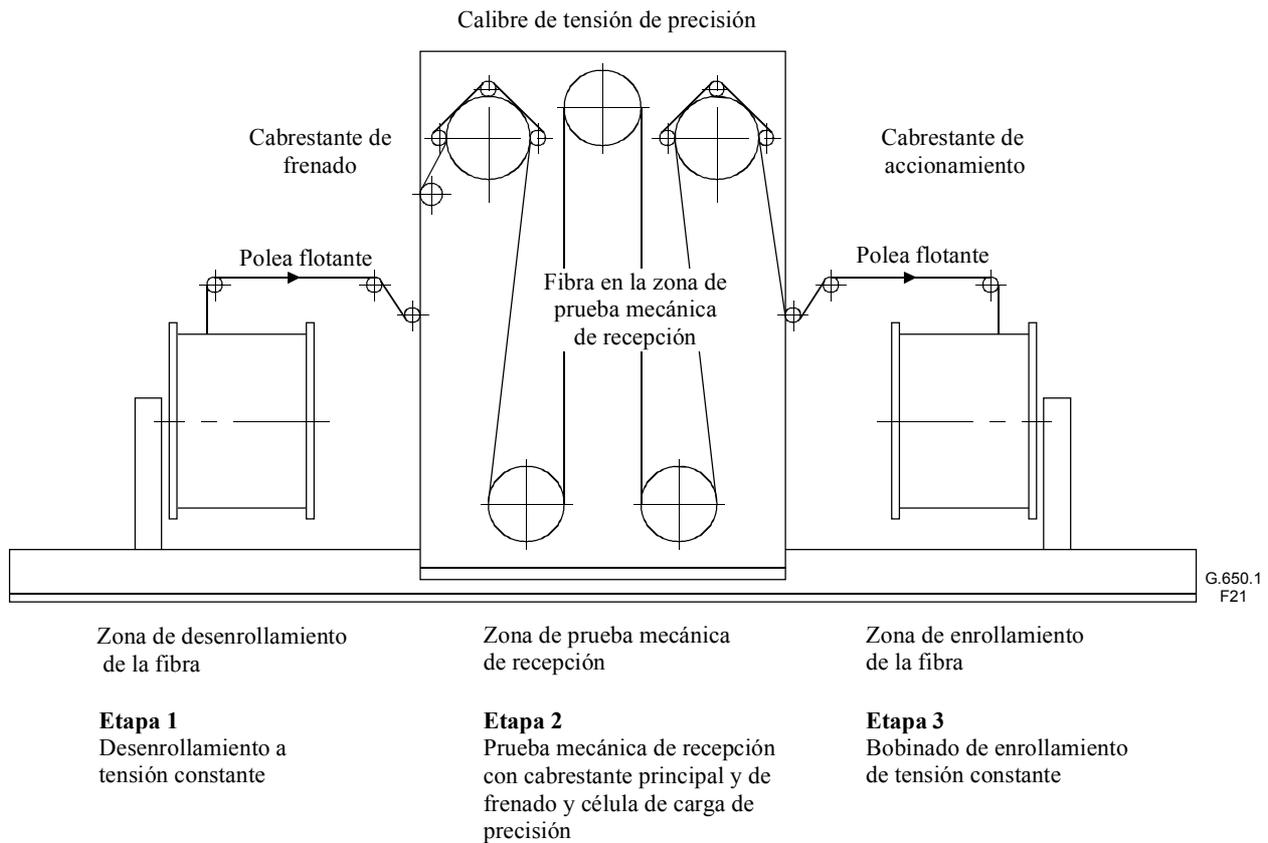
**Figura 21/G.650.1 – Configuración típica de una máquina de prueba mecánica de recepción de cabrestantes frenados**
