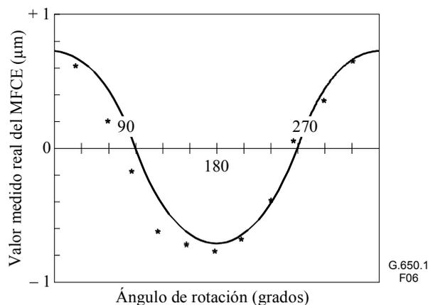
**Figura 6/G.650.1 – Valor medido del error de concentricidad de núcleo en función del ángulo de rotación**
