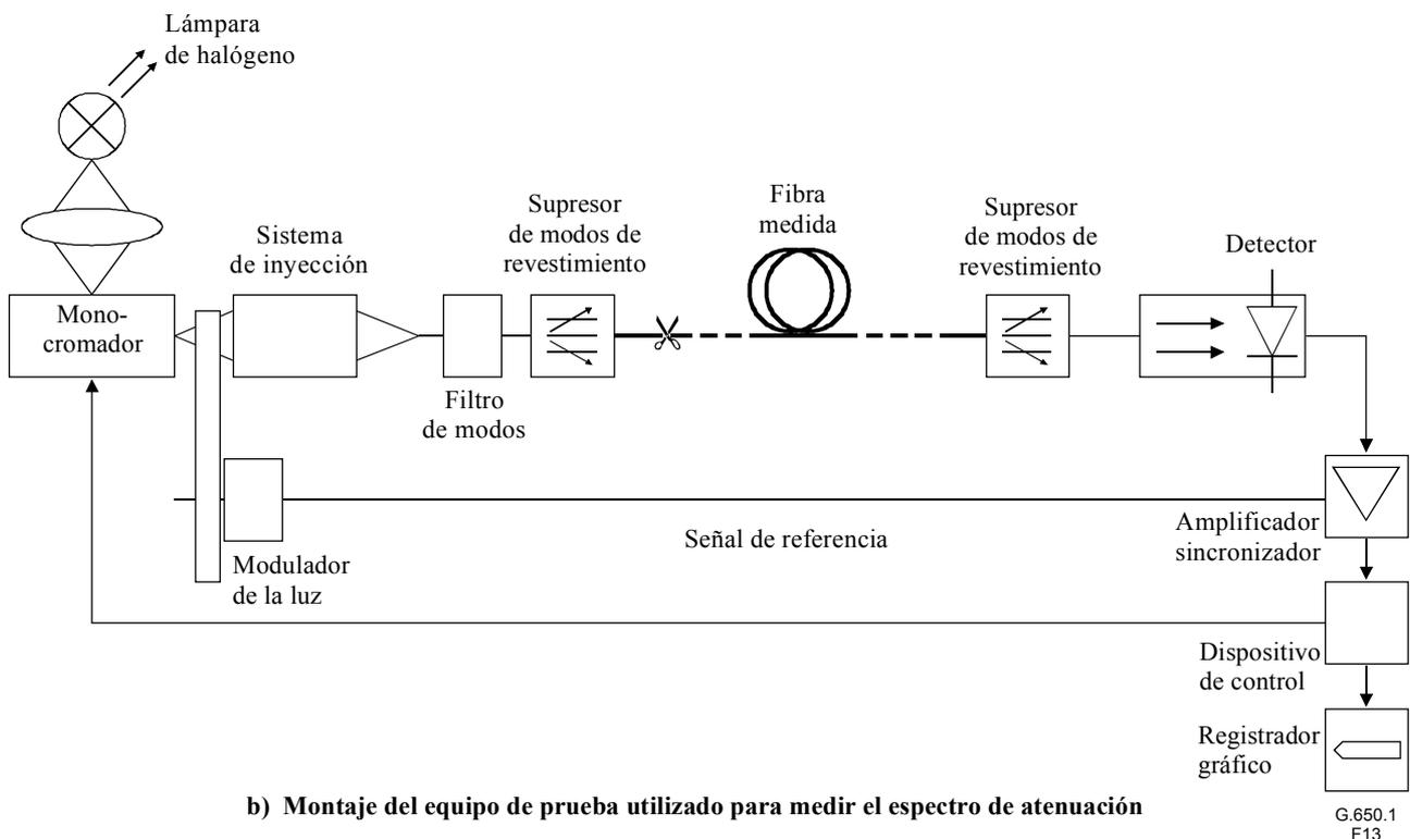
b) Montaje del equipo de prueba utilizado para medir el espectro de atenuación
