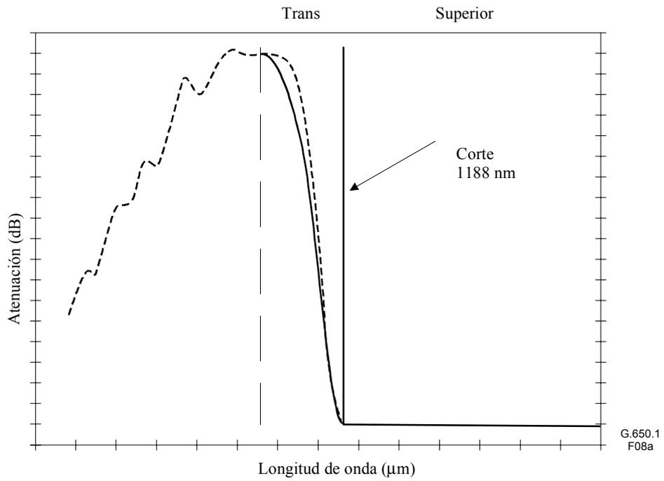
**Figura 8a/G.650.1 – Representación de la longitud de onda de corte de referencia monomodo**
