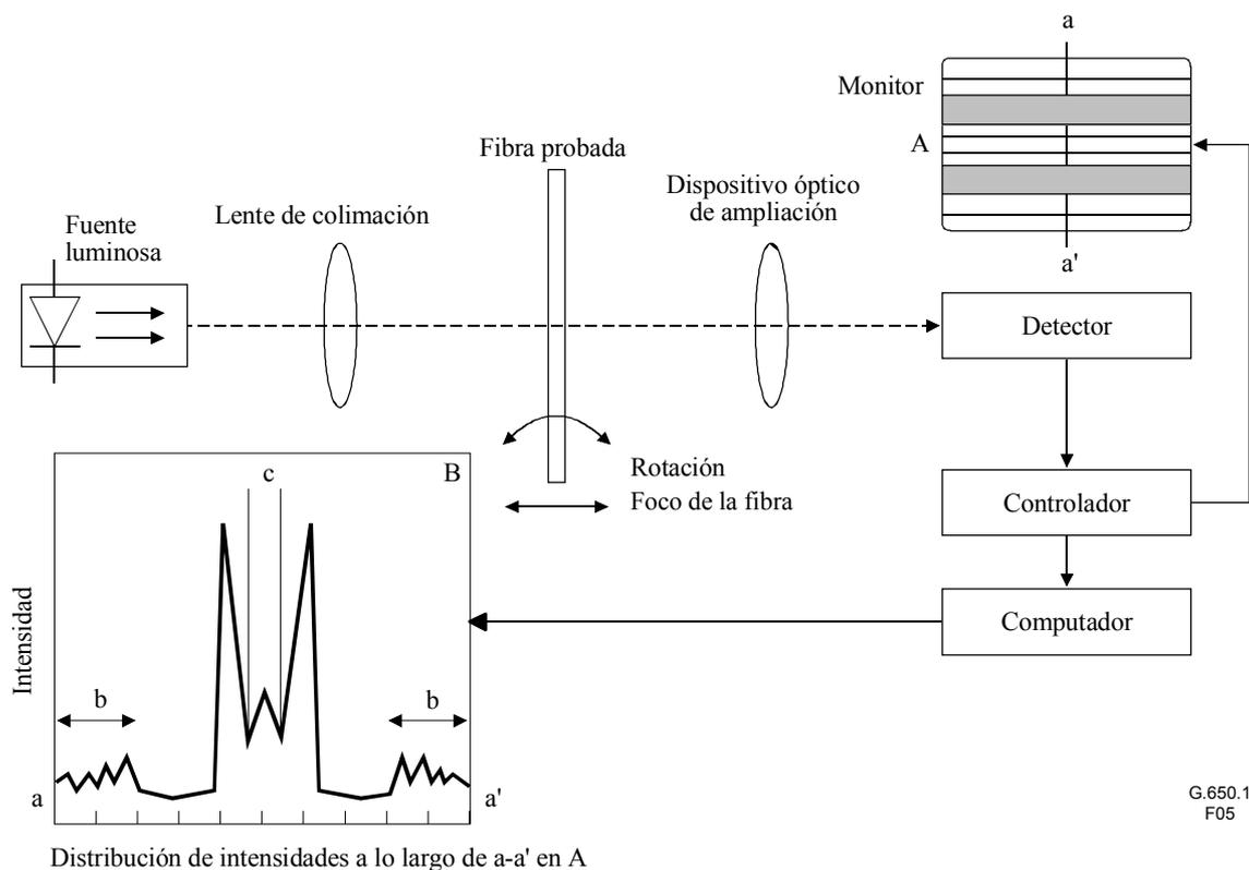
**Figura 5/G.650.1 – Diagrama esquemático del sistema de medición de visión lateral**
