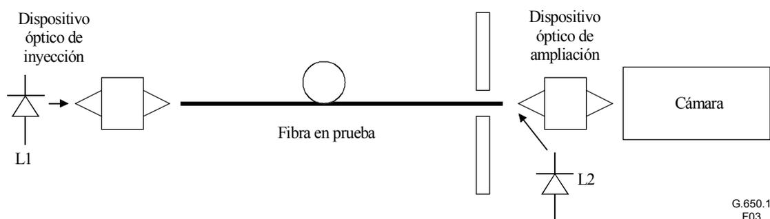
Figura 3/G.650.1 – Esquema del aparato de prueba
