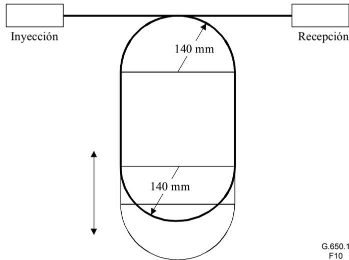
**Figura 10/G.650.1 – Instalación de la fibra: Longitud de onda de corte por la técnica del mandril dividido**
