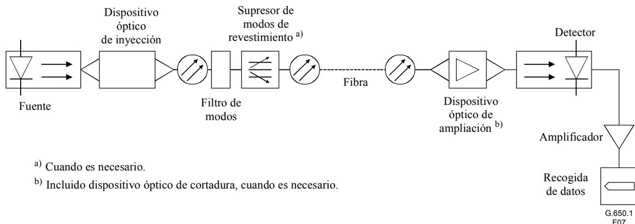
**Figura 7/G.650.1 – Configuración de prueba típica de la técnica de campo próximo transmitido**
