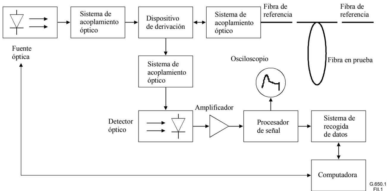
**Figura II.1/G.650.1 – Esquema del aparato para la medición de la uniformidad de la dispersión cromática**
