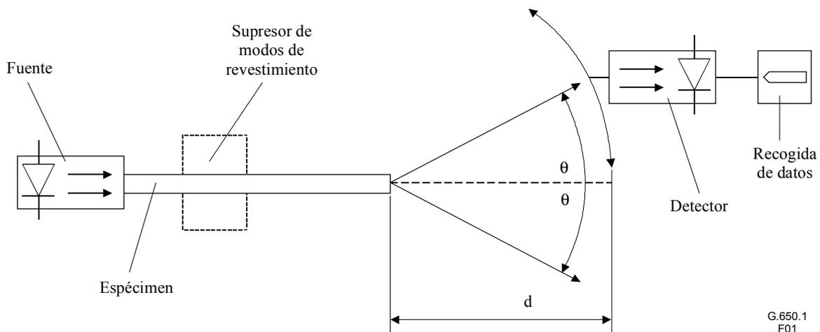
Figura 1/G.650.1 – Configuración de prueba típica de la exploración de campo lejano
