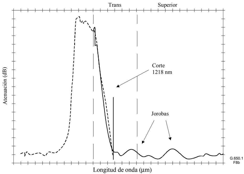
**Figura 8b/G.650.1 – Representación de la longitud de onda de corte de referencia monomodo con jorobas**
