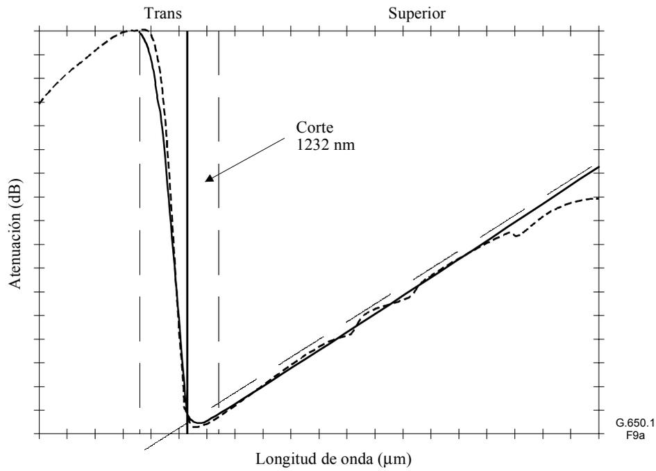
**Figura 9a/G.650.1 – Representación de la longitud de onda de corte de referencia multimodo**
