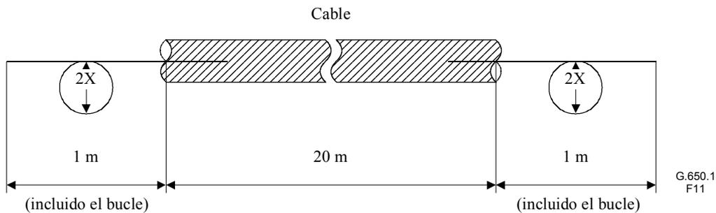
**Figura 11/G.650.1 – Condición de instalación para la medición de la longitud de onda de corte de una fibra cableada**
