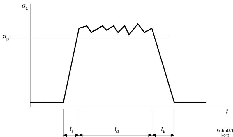
**Figura 20/G.650.1 – Tensión mecánica  $\sigma$  en función del tiempo  $t$ , durante la prueba mecánica de recepción**
