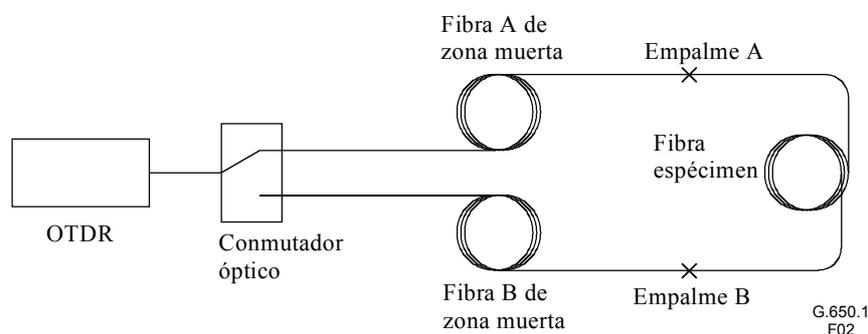
**Figura 2/G.650.1 – Aparato facultativo para la retrodispersión bidireccional**
