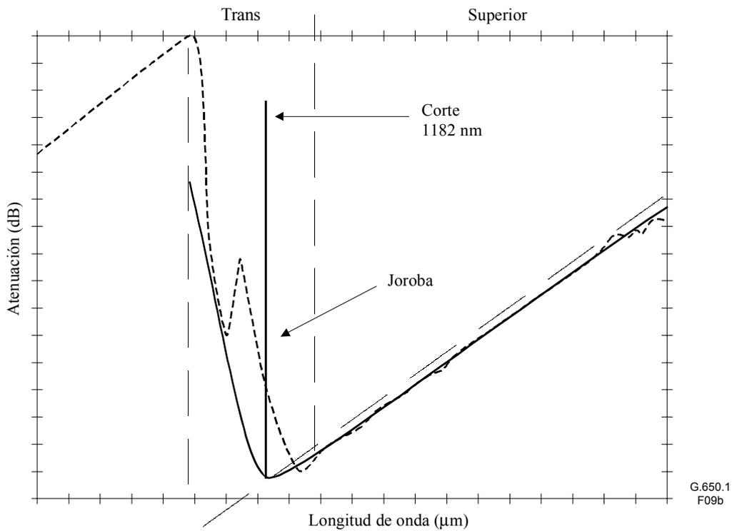
**Figura 9b/G.650.1 – Representación de la longitud de onda de corte de referencia multimodo con joroba**
