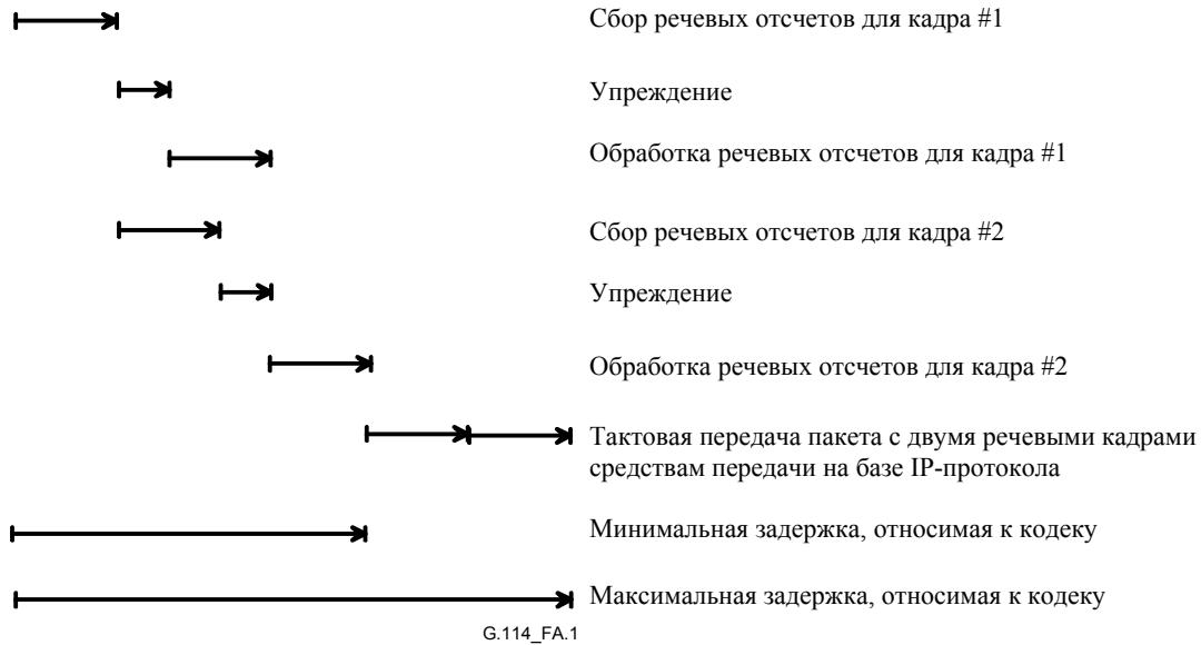
**Рисунок А.1/G.114 – Пример: состав суммарной связанный с кодеком задержки в IP-среде для N = 2**
