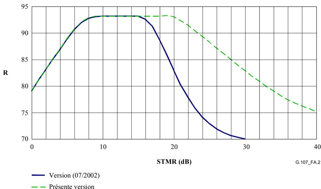
**Figure A.2/G.107 – Comparaison de la valeur de  $R$  par rapport au STMR dans la présente version de l'algorithme du modèle E et dans sa version antérieure**
