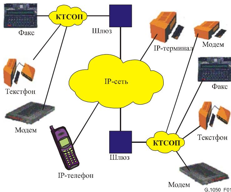
Рисунок 1/G.1050 – Модель сети для оценки рабочих характеристик передачи мультимедиа
