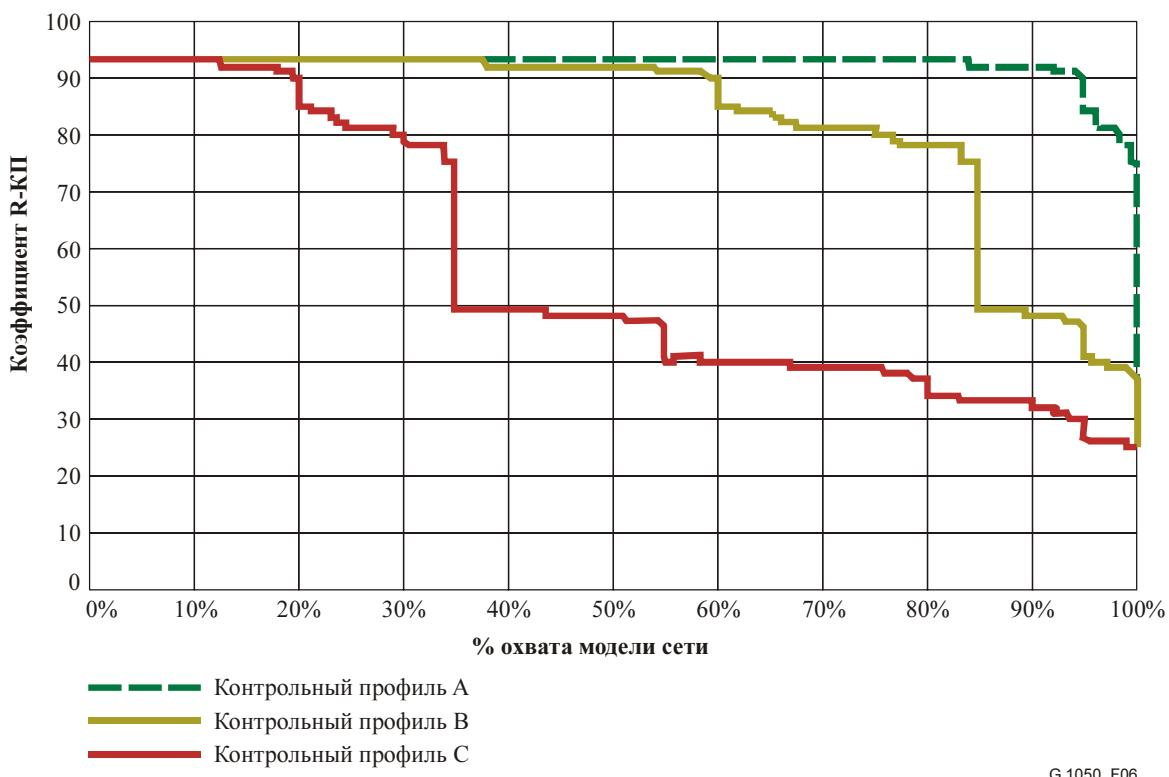
**Рисунок 6/G.1050 – Кривые охвата типовой сети с использованием коэффициента R – качества прослушивания (буфер дрожания 40 мс)**
