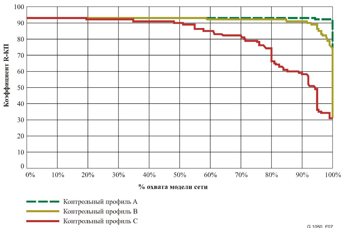
**Рисунок 7/G.1050 – Кривые охвата типовой сети с использованием коэффициента R – качества прослушивания (буфер дрожания 100 мс)**
