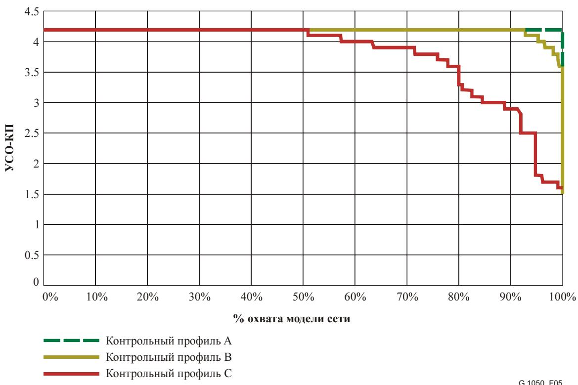
**Рисунок 5/G.1050 – Кривые охвата типовой сети с использованием УСО – качества прослушивания (буфер дрожания 100 мс)**
