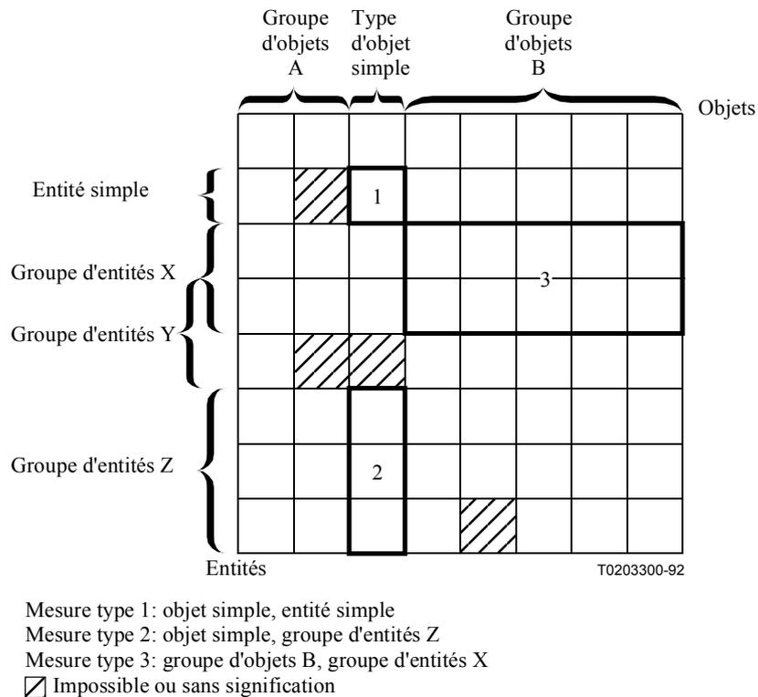
**Figure 1/E.502 – Matrice de mesure**
