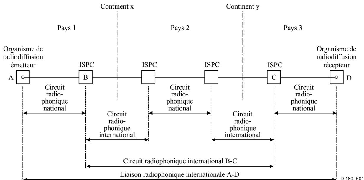
Figure 1/D.180 – Exemple de liaison radiophonique internationale
