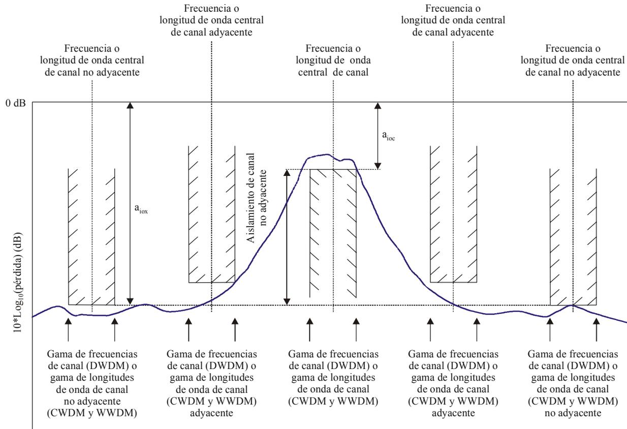
Frecuencia óptica (THz) para DWDM o longitud de onda (nm) para CWDM y WWDM
