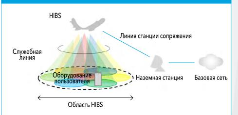
HIBS = станции на высотной платформе, действующие в качестве базовых станций IMT Источник: Документ 5D/1361, МСЭ.
