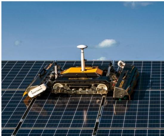
Robot de nettoyage à sec des panneaux solaires
