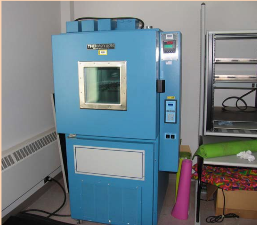
Figure 11: Chambre thermique pour tests de stabilité des fréquences
