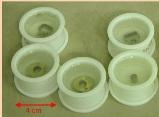
Figura J.2: muestras sobre resina epoxy termoendurecida
