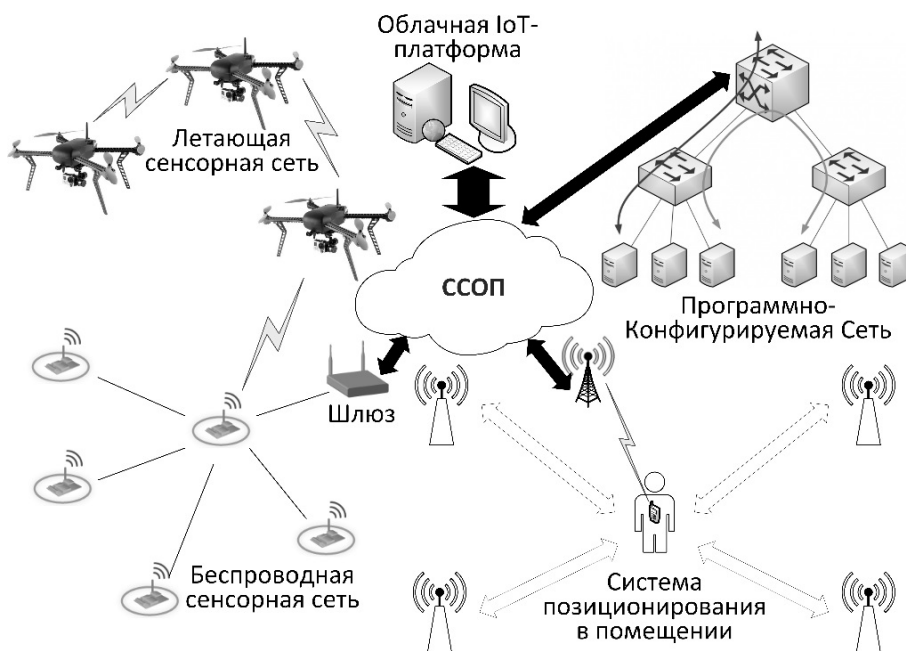
Рисунок 1. Структура модельной сети для тестирования «Интернета вещей»
