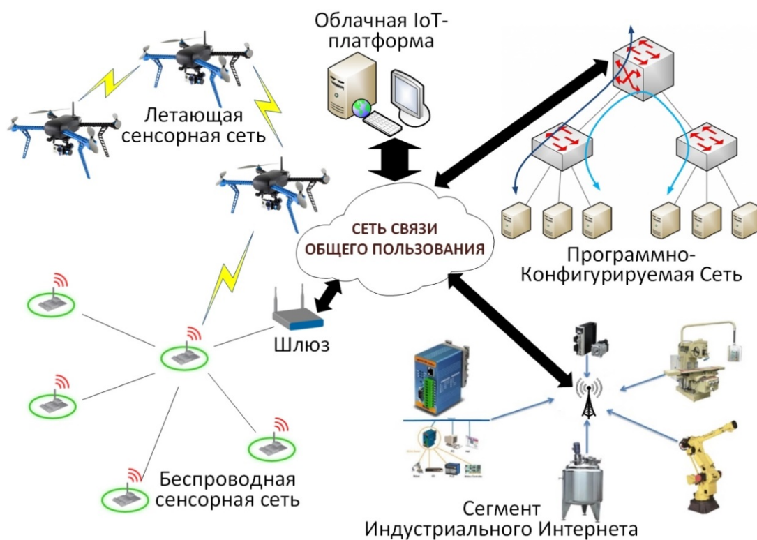
Рисунок 2. Структура модельной сети лаборатории «Интернета вещей» с сегментом индустриального Интернета
