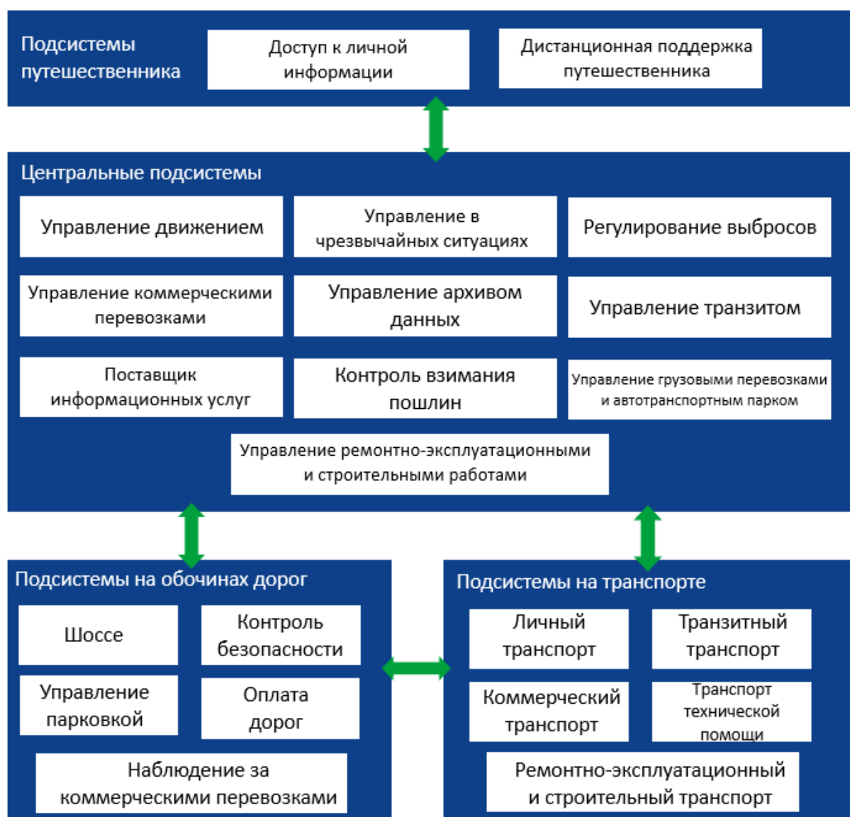
Рисунок 3 – Общая информация о коммуникационной архитектуре ИТС
