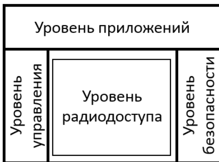
Рисунок 8 – Коммуникационная эталонная модель системы DSRC
