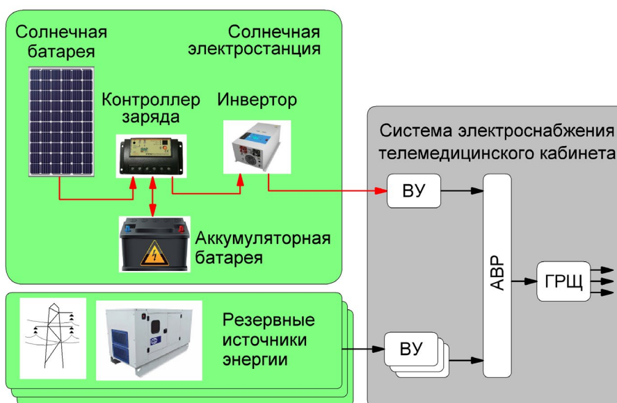
Рисунок 4. Структурная схема автономной СЭС
