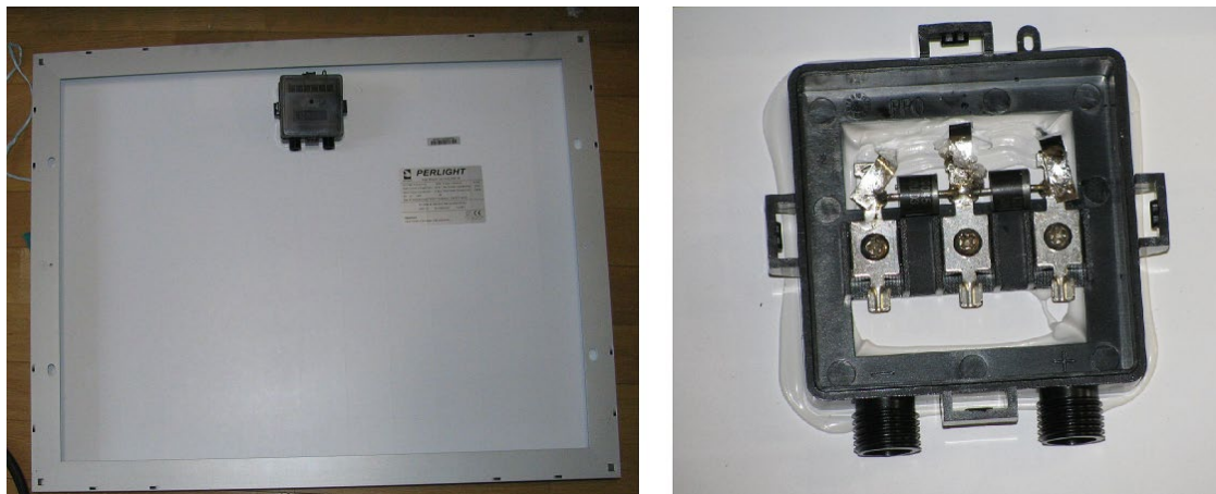
Рисунок 37. Распределительная коробка для подключения проводов солнечной панели
