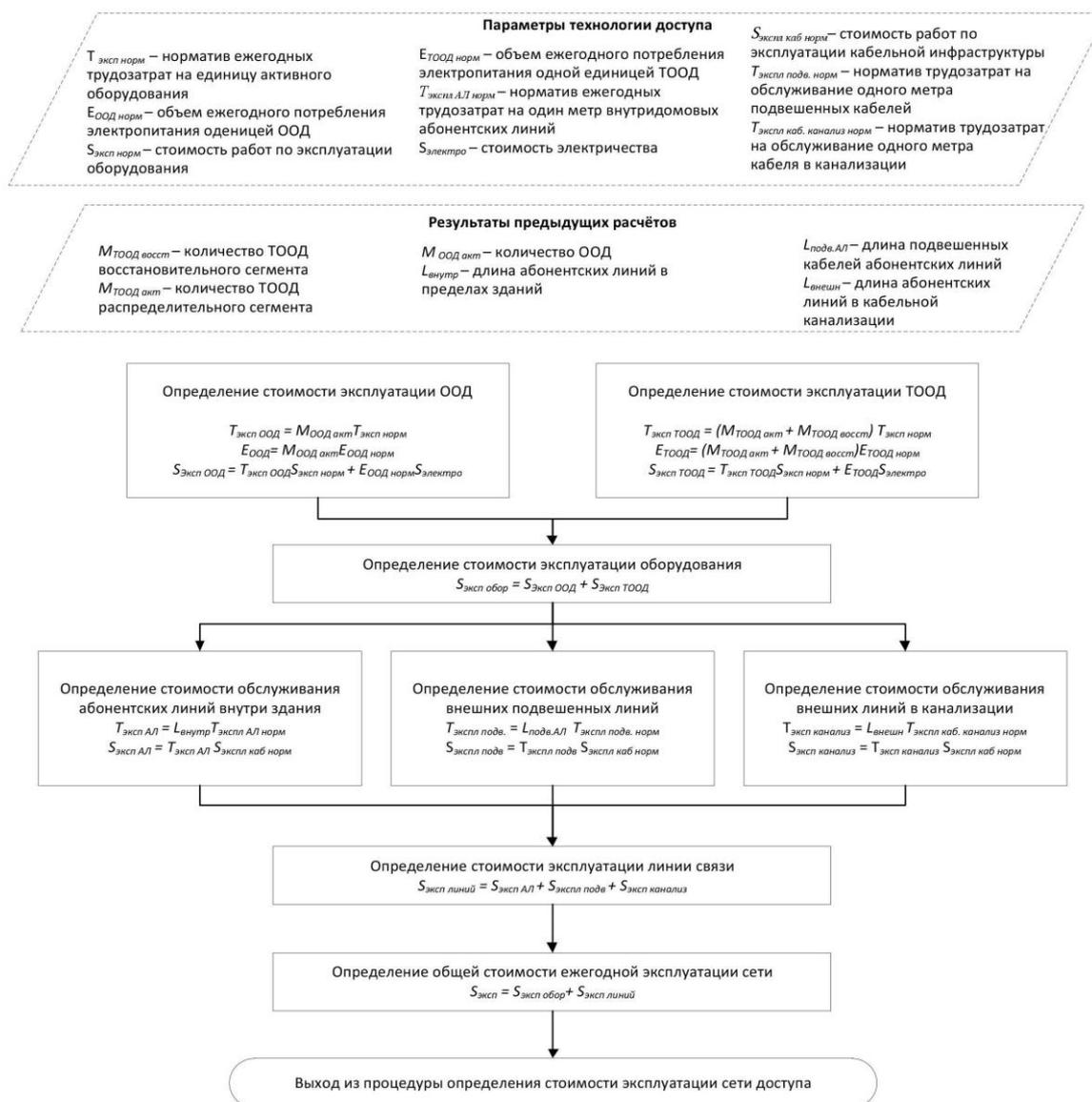
Рисунок 3.10 – Алгоритм определения стоимости эксплуатации сети доступа
