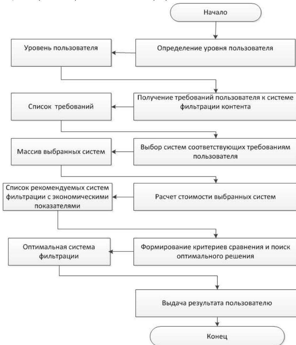
Рисунок 2 – Алгоритм выбора системы фильтрации контента
