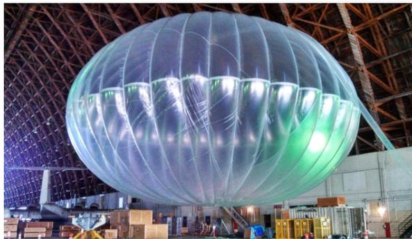
Воздушные шары движутся в стратосфере на высоте около 20 км. Воздушные шары связываются друг с другом, базовыми стационарными станциями на земле и клиентами с помощью специализированного оборудования и антенн
