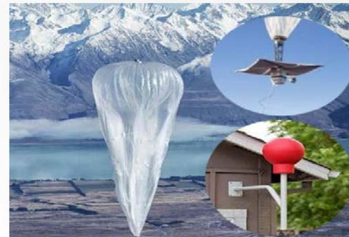
Для получения доступа к Интернету необходимо установить специальную антенну, с помощью которой выполняется соединение с приёмо-передающей аппаратурой шара на гражданских частотах 2.4 и 5.8 ГГц
