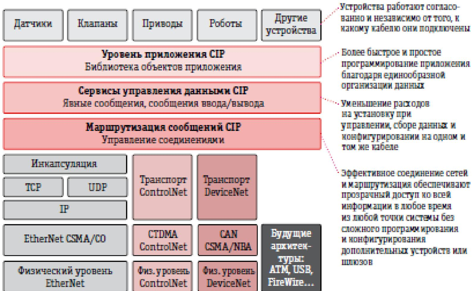
Протокол CIP обеспечивает общую объектную модель и профили устройств для EtherNet, ControlNet и DeviceNet
