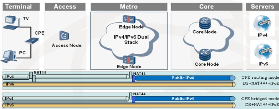
Абонент подключен по Ethernet (Dual Stack +NAT)
