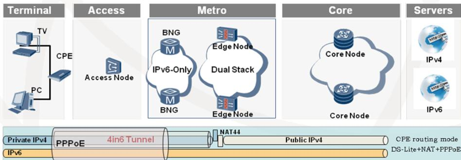
Абонент подключен по PPPoE Dual Stack-Lite
