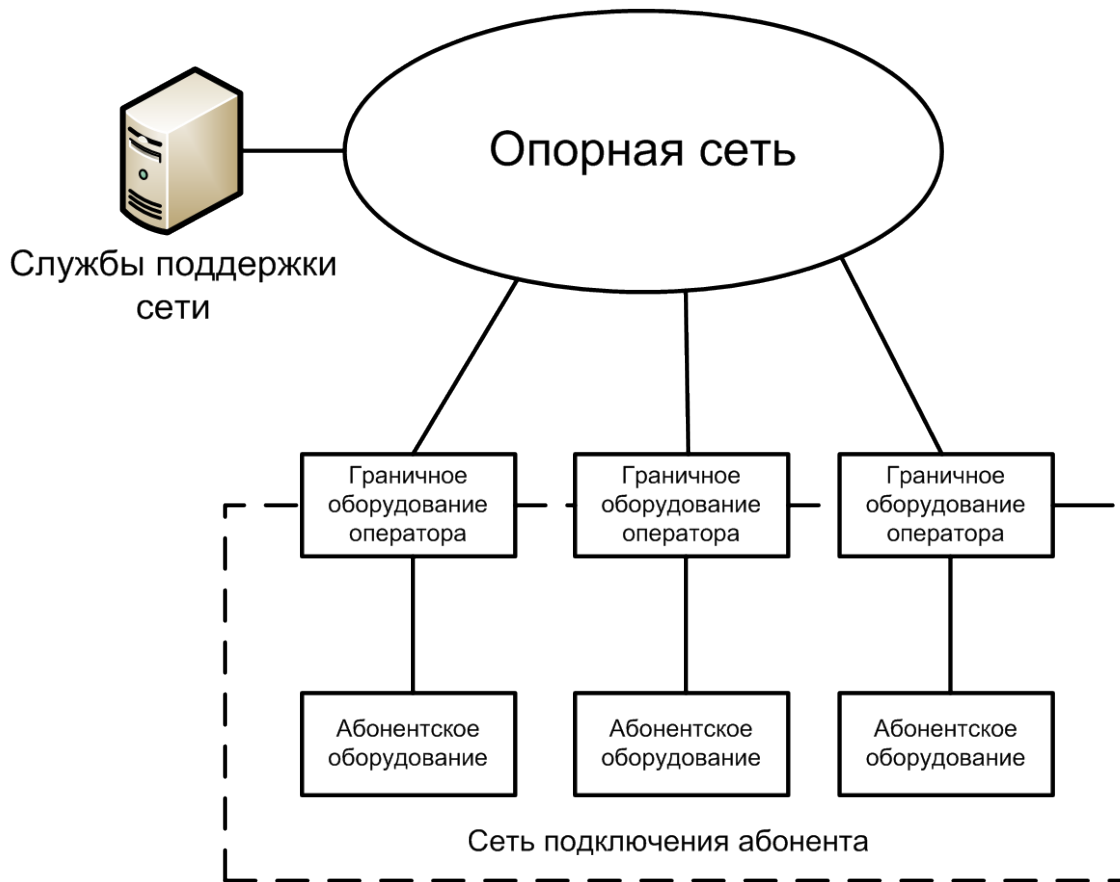
Обобщенная структура сети передачи данных оператора
