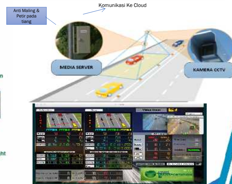
Desain CCTV Jalan Raya Dengan Fitur Video Analytic
