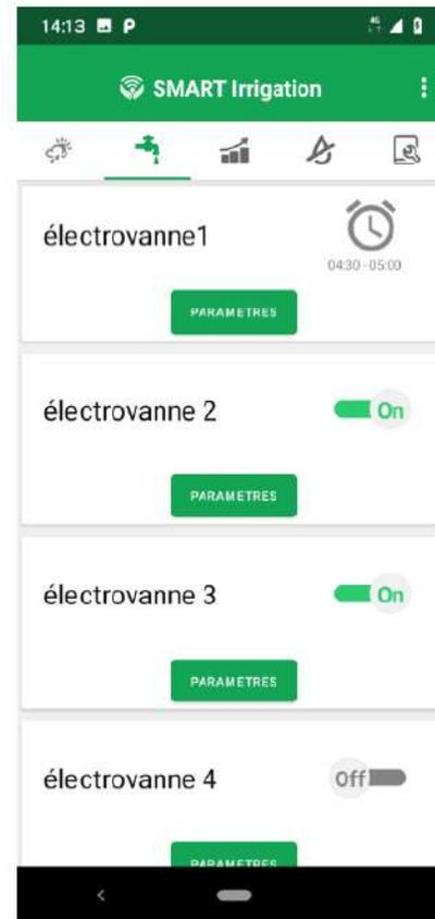
Figure 3: interface d'irrigation
