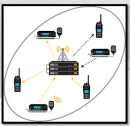
Puede operar de forma autónoma en modo site trunking, cuando existe la ausencia de enlace terrestre al controlador maestro, con posibilidad de recuperación con conexión satelital.
