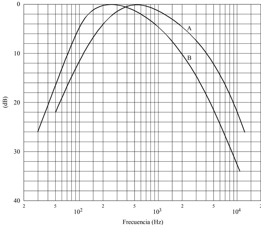
Curvas A: Espectro del ruido normalizado (medido con filtros de un tercio de octava)
