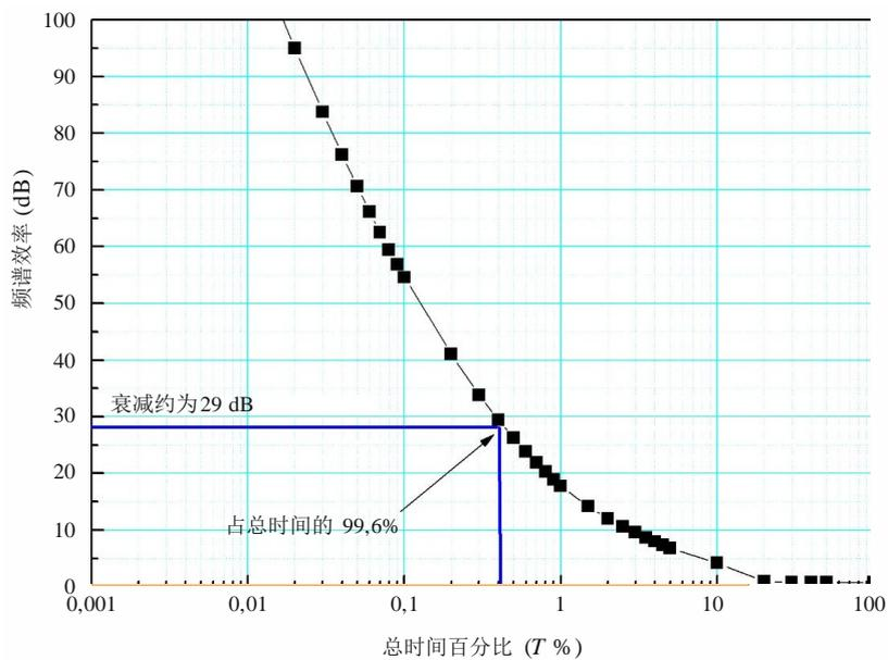
假设如图4所示，卫星连接的衰减是总时间的函数，那么可以预期的损失吞吐量的平均值将是总可能吞吐量的4.678%。
