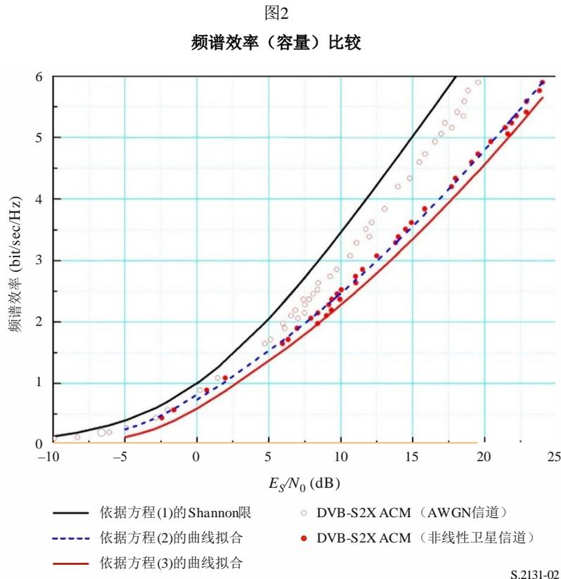
通过使用两个最小二乘最小误差二阶多项式来拟合非线性卫星信道上的DVB-S2X ACM操作的频谱效率，可以得出以下方程式<sup>9</sup>。
