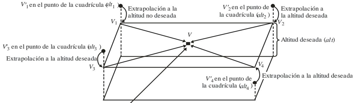
Interpolación bilineal  $V$ , a la latitud, longitud y altitud deseadas a partir de los cuatro puntos de la cuadrícula extrapolados a la misma altitud
