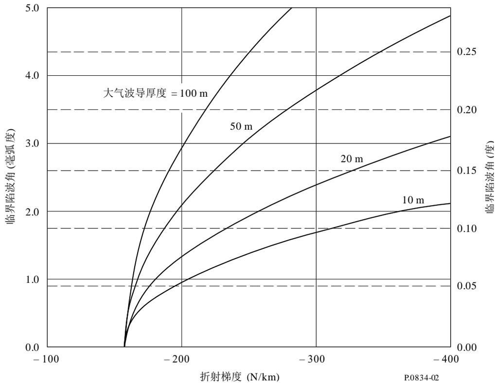
对于其折射梯度仅稍大于产生大气波导效应所需要的最小值的大气层而言，实际上最低陷波频率会提高，高于等效表面大气波导情况下的数值。但是，对于大气波导梯度很强的情况下，对任何给定的频率，高层大气波导造成的陷波效应要求的大气波导层的厚度比等梯度的表面大气波导层的厚度要薄得多。
