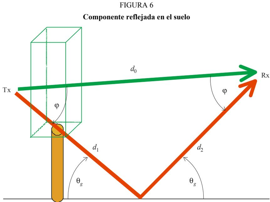
Para calcular las pérdidas experimentadas en el receptor por la onda reflejada en el suelo, puede determinarse el coeficiente de reflexión,  $R_0$ , de la señal reflejada en el suelo con un determinado ángulo rasante,  $\theta_g$ . Se trata de un método normalizado que se describe en la Recomendación UIT-R P.1238. Los valores de permitividad y conductancia se obtienen de la Recomendación UIT-R P.527.
