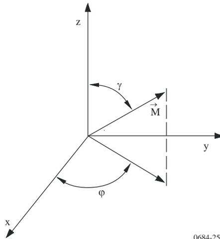
Selon la Fig. 25,  $\gamma = 0^\circ$  représente l'excitation d'un dipôle vertical, tandis que  $\gamma = 90^\circ$  indique l'excitation d'un dipôle horizontal. En outre,  $\varphi$  est l'angle entre la direction du dipôle horizontal et la direction de propagation. De manière explicite,  $\varphi = 0$  représente le rayonnement longitudinal et  $\varphi = 90^\circ$  représente le rayonnement transversal.
