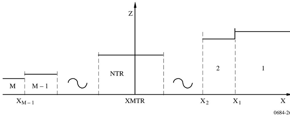
Ici encore, comme dans le cas de la procédure de sommation du mode WKB, le calcul du champ peut être fait pour des excitateurs de doublet électrique d'orientation arbitraire situés à une hauteur quelconque dans le guide. Il est ainsi possible de traiter les problèmes de propagation air-air, sol-air ou air-sol aux ondes myriamétriques et kilométriques dans une voie de guide d'ondes horizontalement non homogène.
