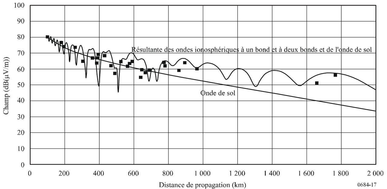
Les Fig. 18 et 19 montrent les courbes de propagation prévues des champs résultants des ondes ionosphériques à un bond et à deux bonds et de l'onde de sol à 60 kHz, respectivement le jour et la nuit, les données sous forme de points ayant été mesurées en février 2004.
