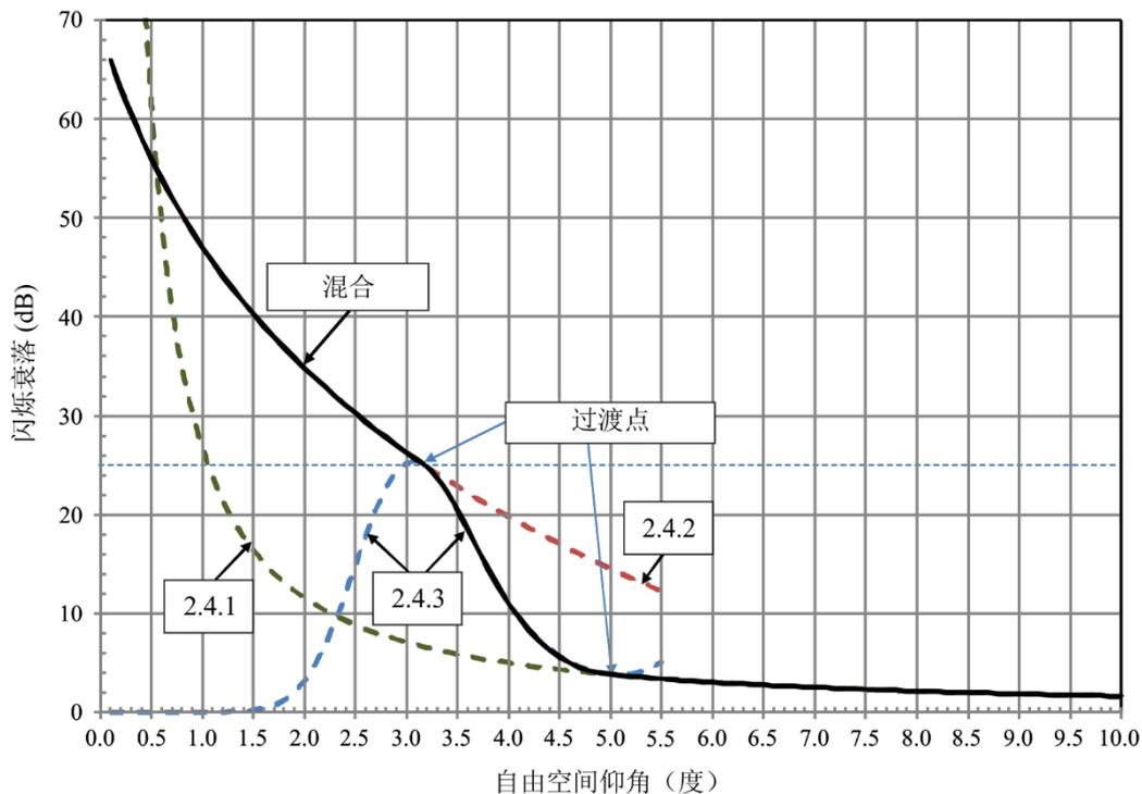
在很小的时间比例内，且同样，在很大的衰减深度内（大于约10度），在很低仰角观测到的闪烁造成的衰减可能十分严重。观测也同时发现衰减与地面业务链路多路径衰减的特性类似。与地面链路衰减深度的分布类似，非常低仰角卫星链路的分布似乎与折射梯度统计数据也有关系。整个衰减分布呈现出从大超越比例的闪烁分布到小超越比例的多路径衰减分布（斜率为10 dB/十年）逐步过渡的状态。第2.4.2和2.4.3段分别关于整体分布中强衰减和浅度衰减部分的预测方法使用了折射斜率统计数据 $p_L$ 来描述分布中的气候变化。
